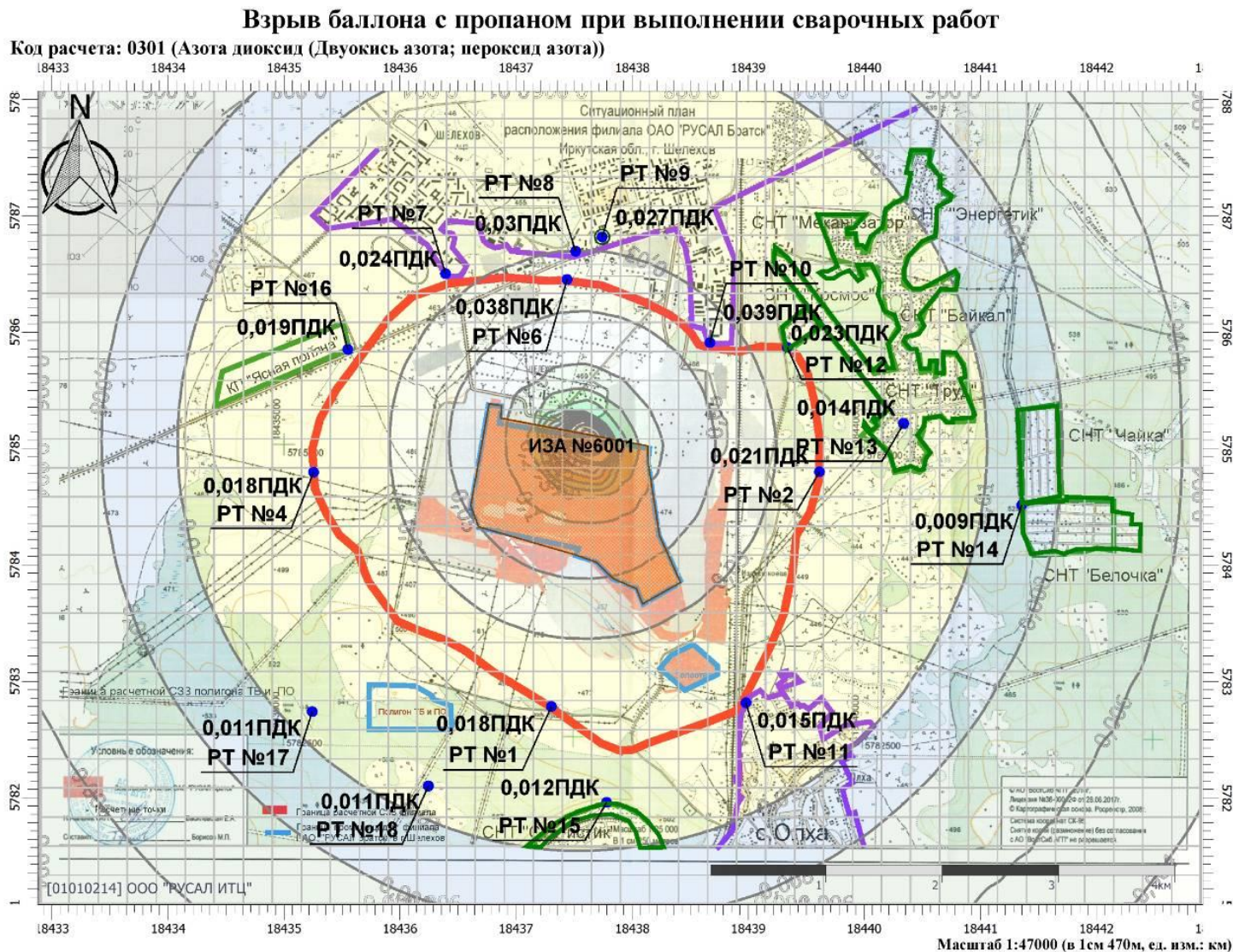
Рисунок 5.12.1.1-1. Результаты расчета рассеивания выбросов диоксида азота при взрыве баллона с пропаном
