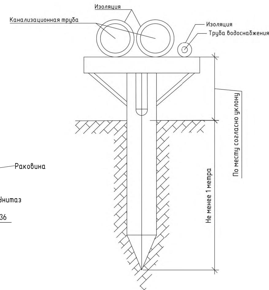
1. Трубопровод наружной канализации прокладывать с греющим кабелем для избежания промерзания трубопровода. После укладки греющего кабеля, для уменьшения теплопотерь предусмотреть покрытие трубопроводов изоляцией из вспененного синтетического каучука фирмы «K-flex». Материал трубопроводов наружной канализации стальные бесшовные горячедеформированные трубы по ГОСТ 8732-78 из стали 9Г2С.
