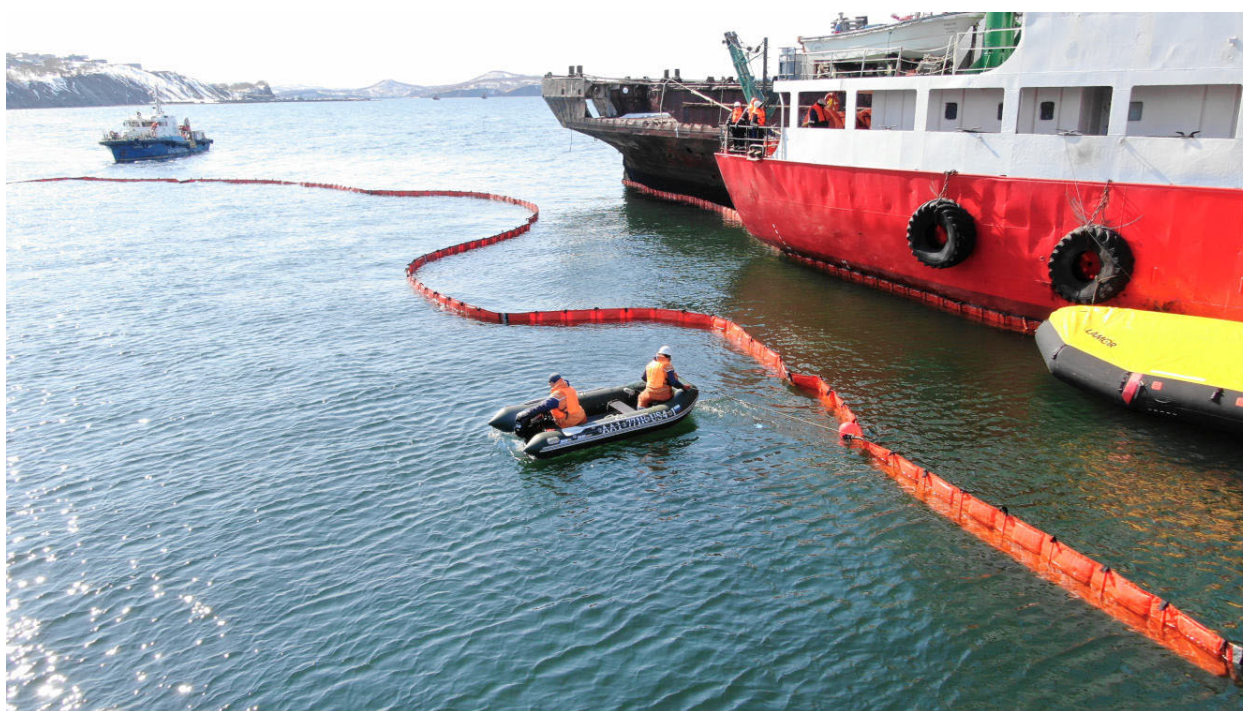
Рисунок 4.9. Постановка бонного ограждения при бункеровке в акватории
