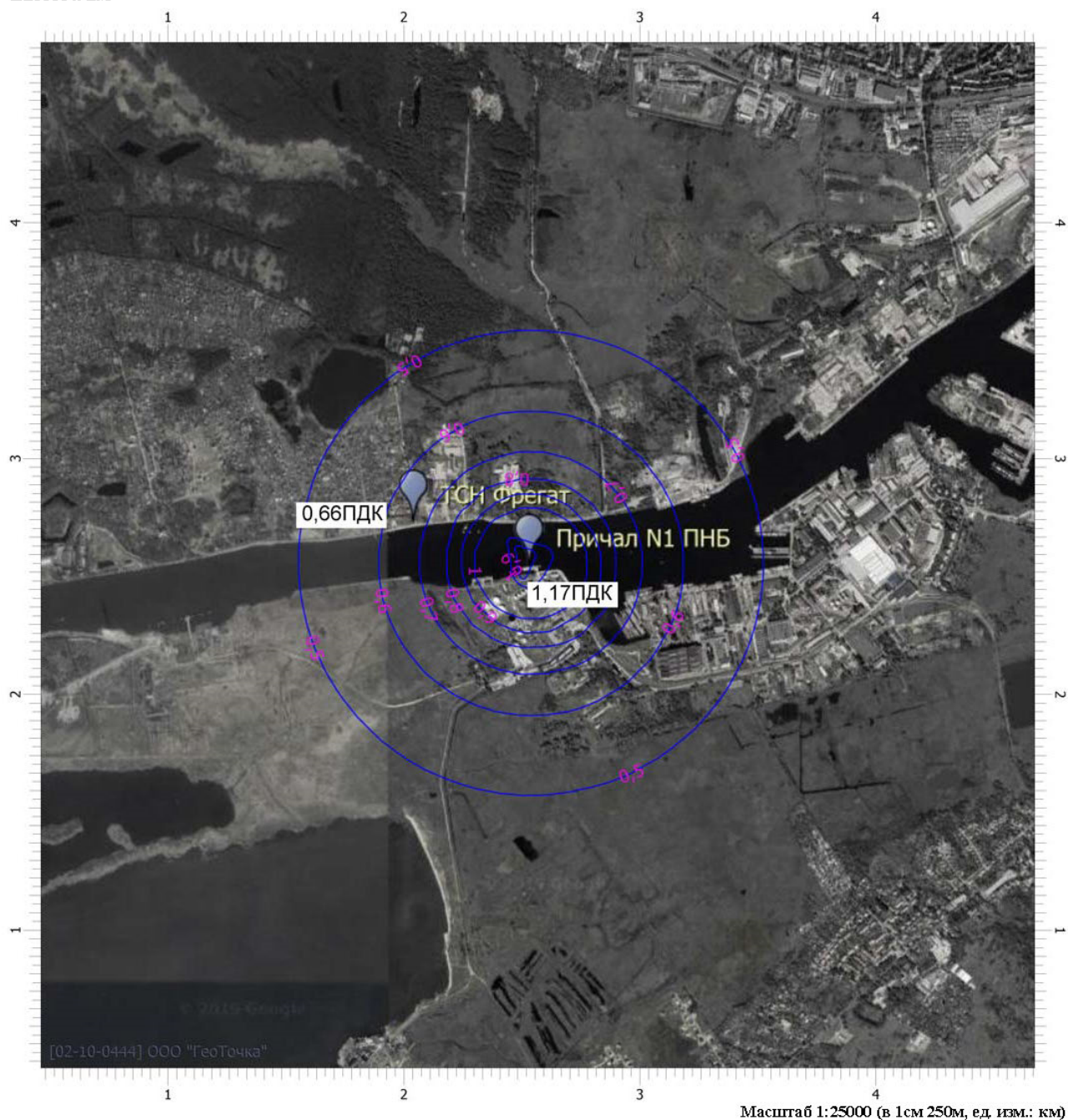
Рисунок 5.9. Схема концентраций при рассеивании диоксида азота в атмосфере в ситуации бункеровки на акватории порта Калининград (портовая нефтебаза)
