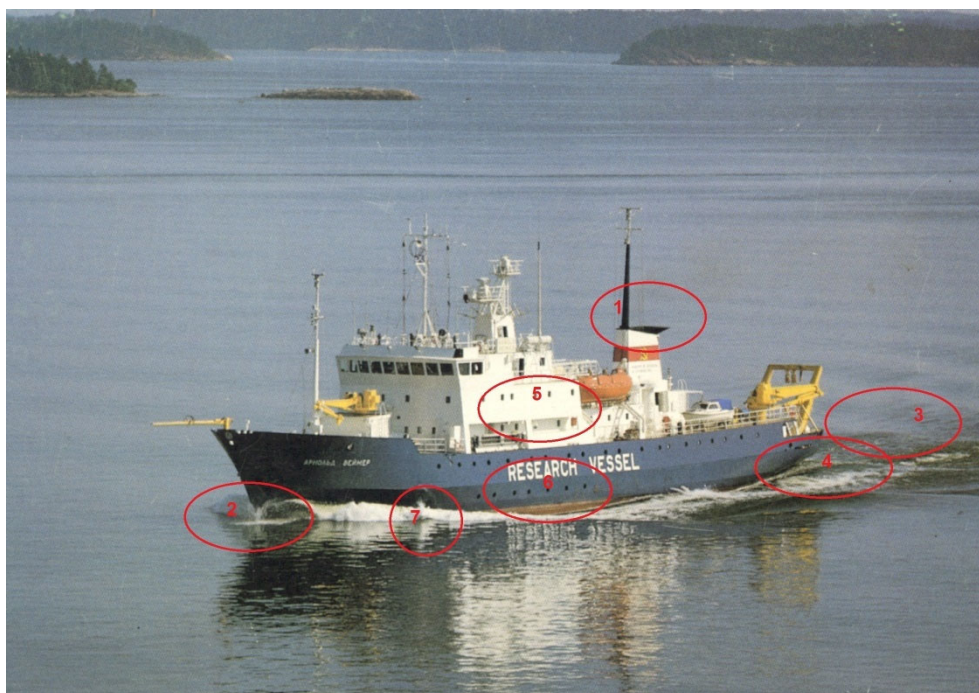
Рисунок 13.1. Основные источники воздушного шума судна
