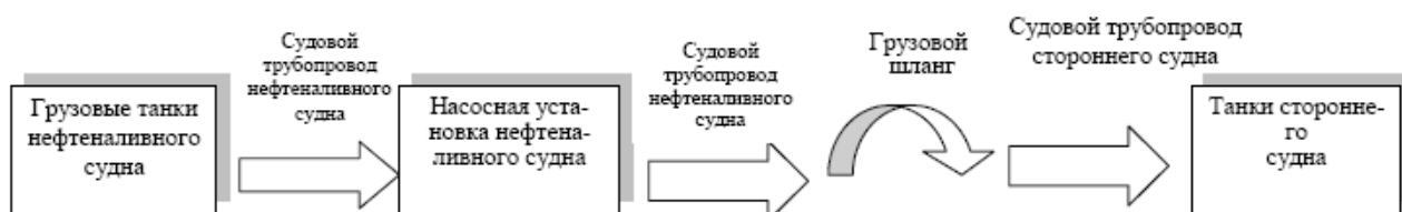
Рисунок 4.6. Технологическая схема отгрузки топлива
