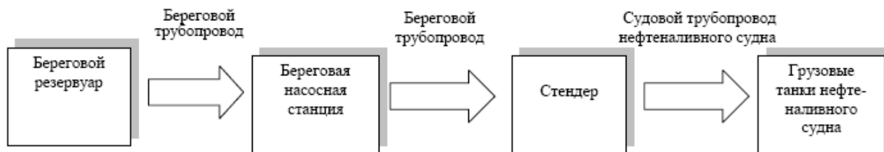
Рисунок 4.5. Технологическая схема загрузки топлива
