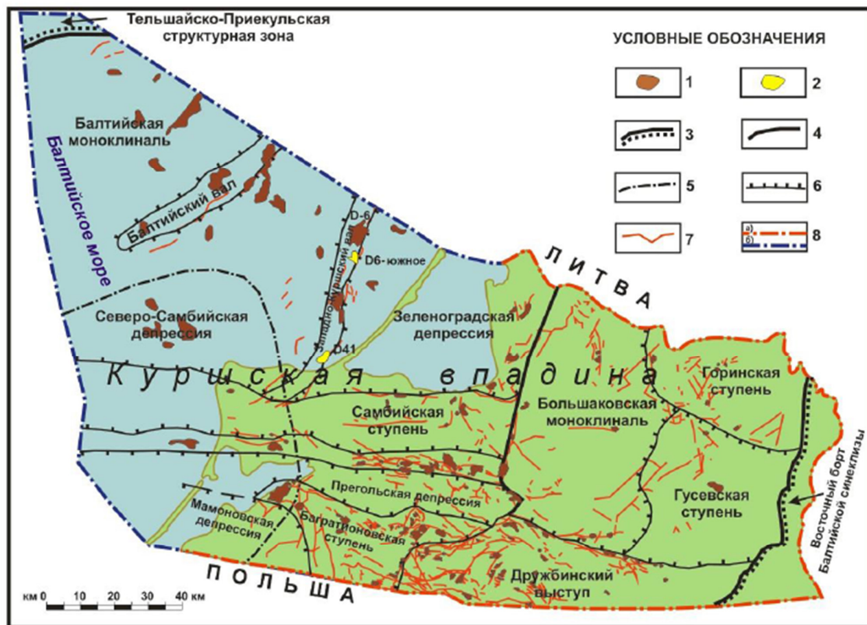
1 – контуры месторождений и нефтегазоперспективных структур; 2 – нефтегазоперспективные структуры, в пределах которых выполнялись инженерно-геологические исследования; 3 – границы структурных элементов I-го порядка; 4-6 – границы структурных элементов II-го порядка; 7 – разрывные нарушения; 8 – границы: а – государственная, б – российского сектора Балтийского моря
