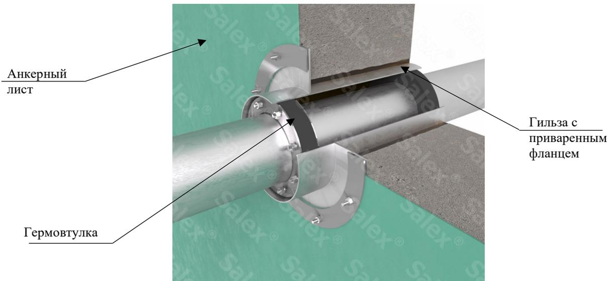
Рисунок 15. Пропуск труб коммуникаций через ж.б. стенку.
