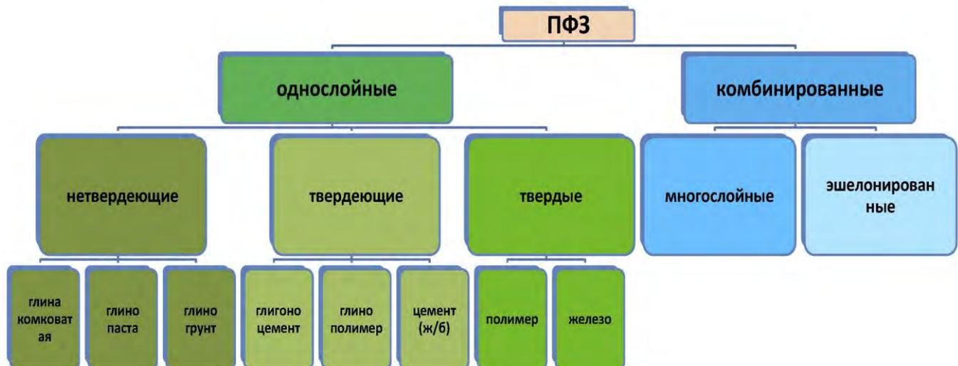
Рис.1. Классификация видов ПФЗ, выполняемых методом стены в грунте
