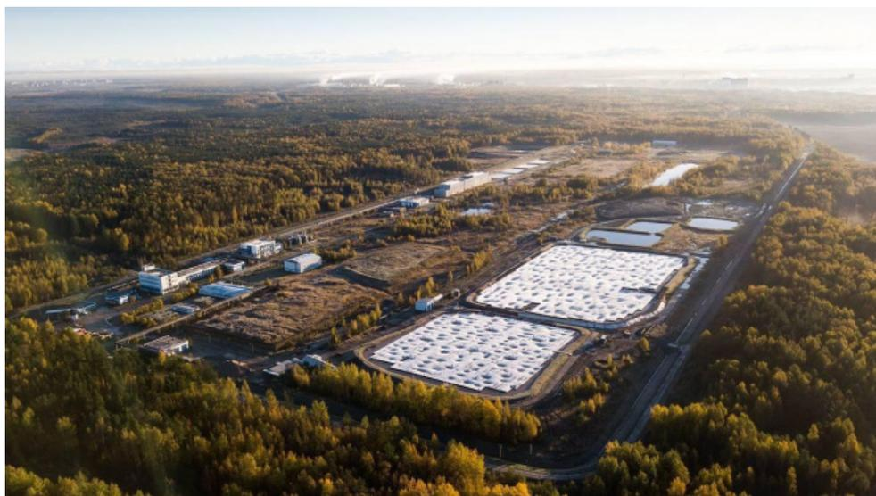
Рисунок 6. Карты полигона. На переднем плане карты №№68, 64 с временным геомембранным покрытием на понтонах.
