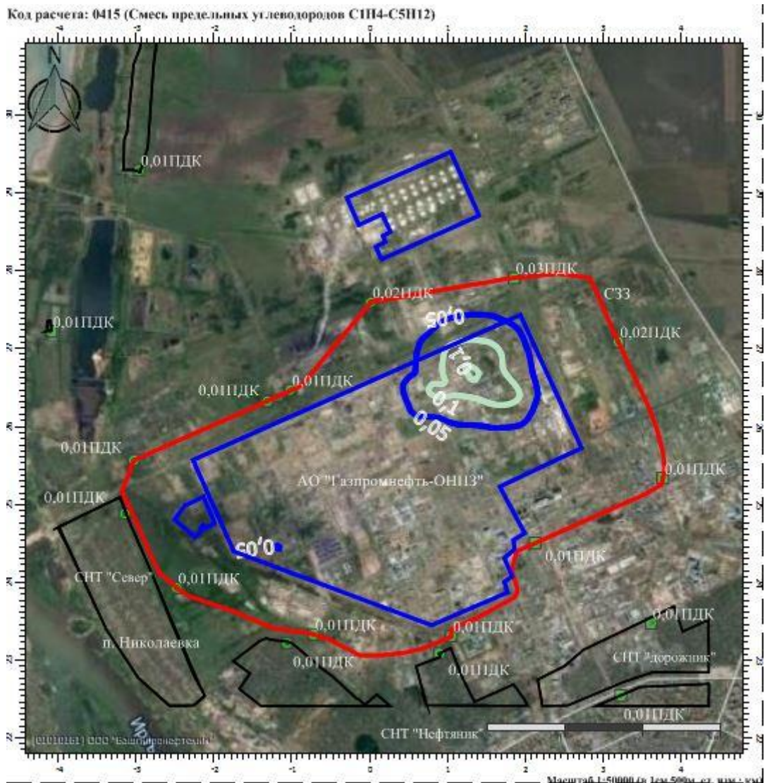
Рисунок 6.1.8 – Карта-схема расчетного загрязнения воздушного бассейна выбросами смеси предельных углеводородов C 1 H 4 -C 5 H 12 от источников АО «Газпромнефть-ОНПЗ» после реализации проектной документации (анодный режим)
