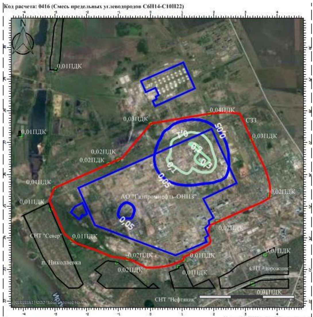
Рисунок 6.1.9 – Карта-схема расчетного загрязнения воздушного бассейна выбросами смеси предельных углеводородов C 6 H 14 -C 10 H 22 от источников АО «Газпромнефть-ОНПЗ» после реализации проектной документации (анодный режим)
