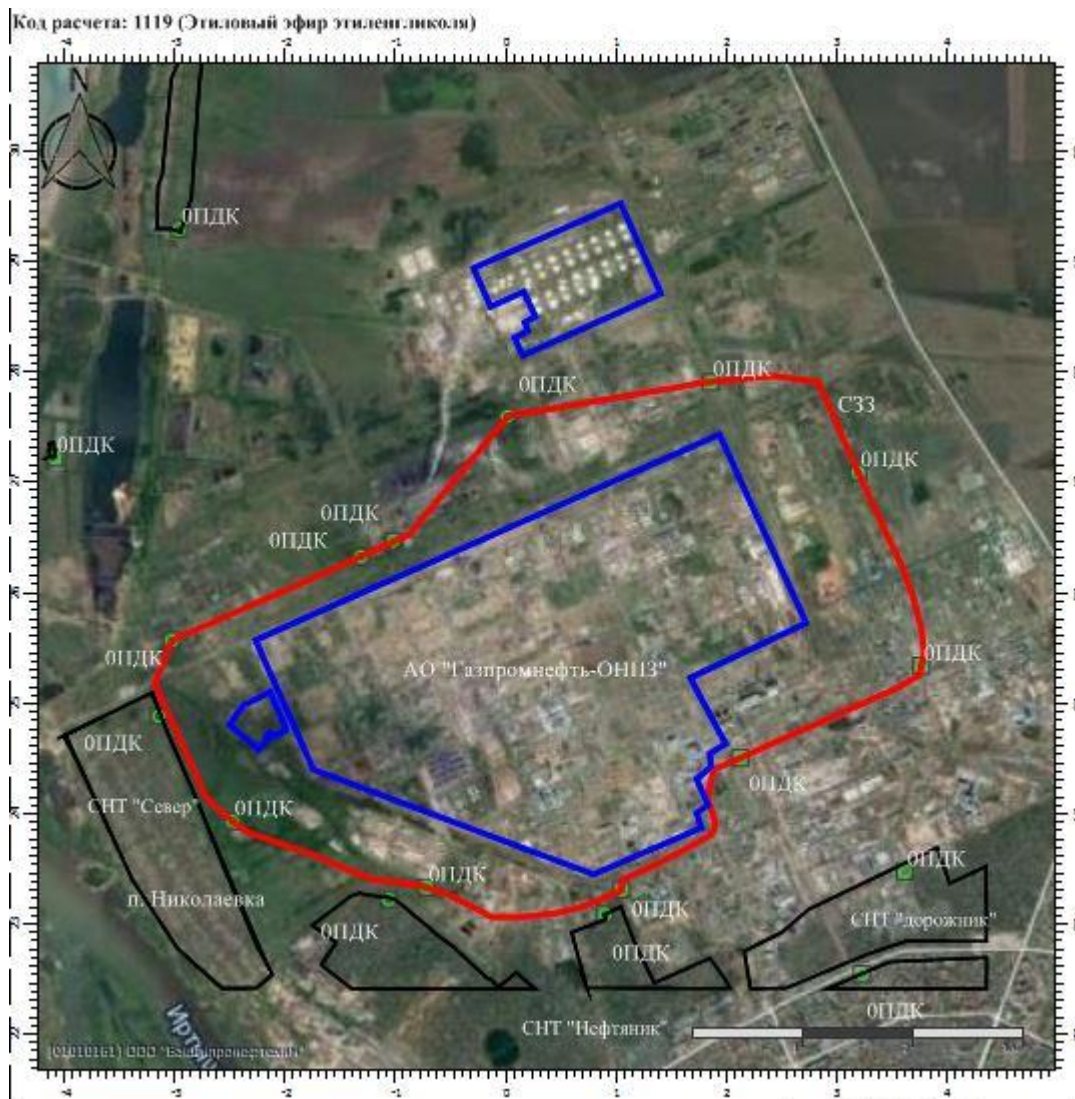
Рисунок 6.1.31 - Карта-схема расчетного загрязнения воздушного бассейна выбросами 2-Этоксизтанола от источников АО «Газпромнефть-ОНПЗ» с учетом проведения строительно-монтажных работ
