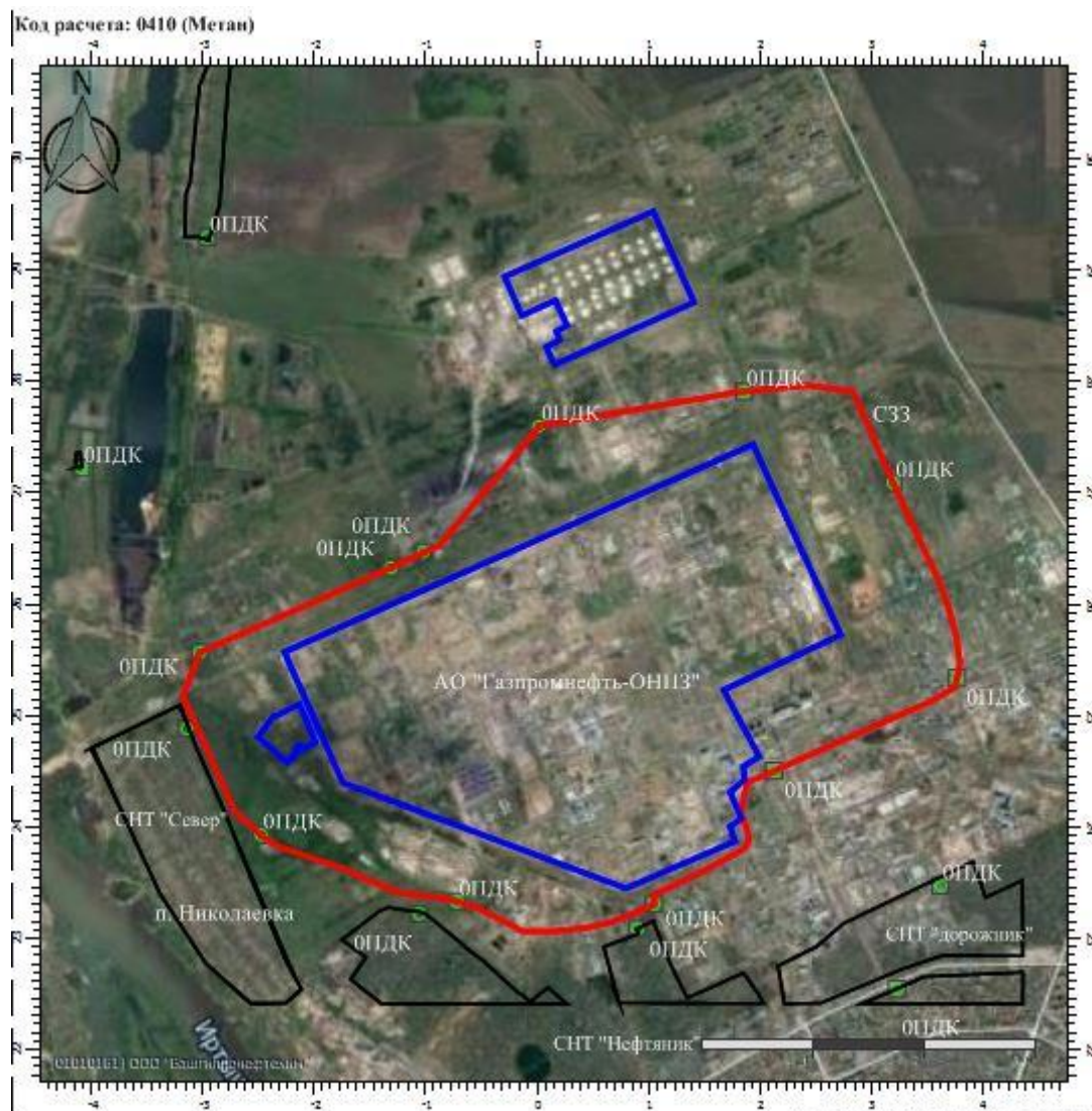
Рисунок 6.1.7 – Карта-схема расчетного загрязнения воздушного бассейна выбросами метана от источников АО «Газпромнефть-ОНПЗ» после реализации проектной документации (анодный режим)
