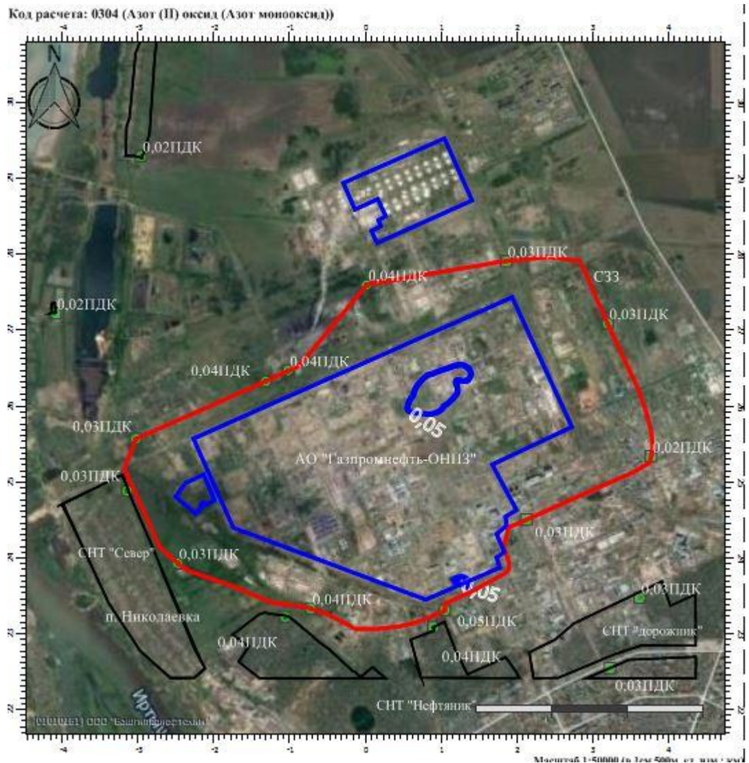
Рисунок 6.1.2 – Карта-схема расчетного загрязнения воздушного бассейна выбросами азота (II) оксида от источников АО «Газпромнефть-ОНПЗ» после реализации проектной документации (анодный режим)
