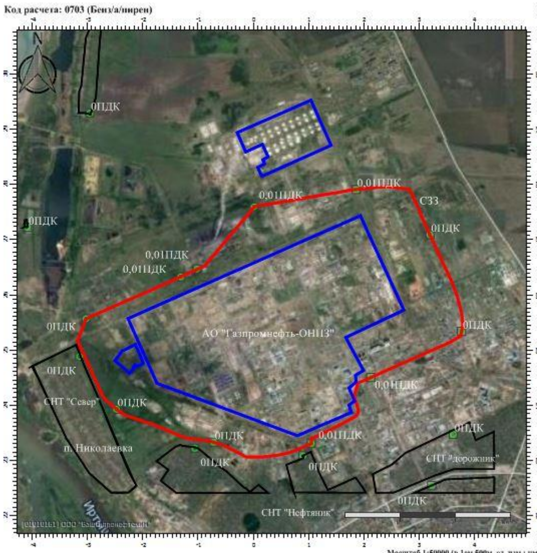
Рисунок 6.1.28 - Карта-схема расчетного загрязнения воздушного бассейна выбросами бенз(а)пирена от источников АО «Газпромнефть-ОНПЗ» с учетом проведения строительно-монтажных работ
