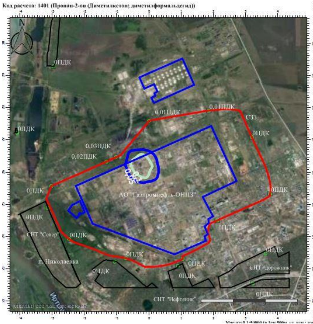
Рисунок 6.1.34 - Карта-схема расчетного загрязнения воздушного бассейна выбросами пропан-2-он от источников АО «Газпромнефть-ОНПЗ» с учетом проведения строительно-монтажных работ
