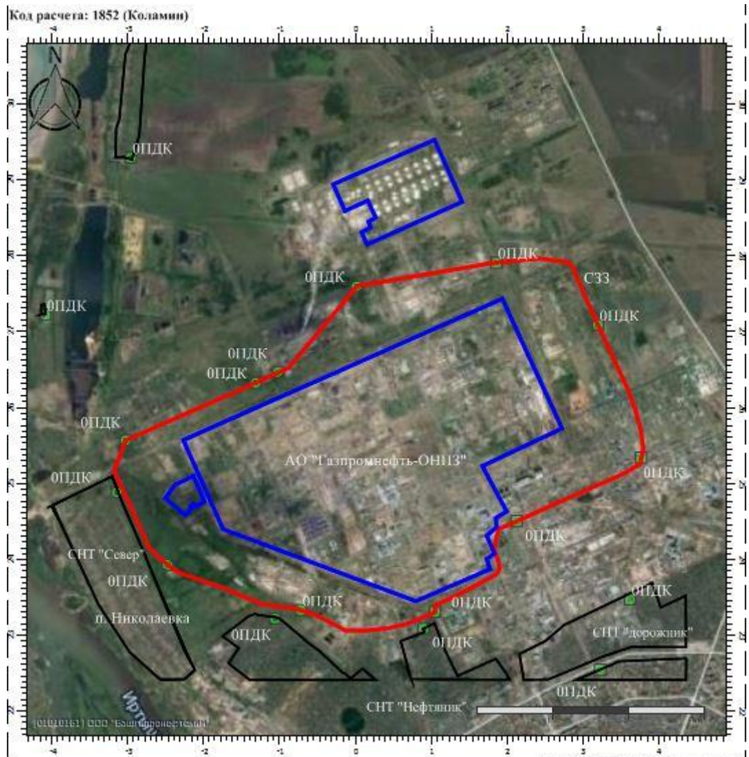
Рисунок 6.1.12 – Карта-схема расчетного загрязнения воздушного бассейна выбросами моноэтаноламина от источников АО «Газпромнефть-ОНПЗ» после реализации проектной документации (анодный режим)
