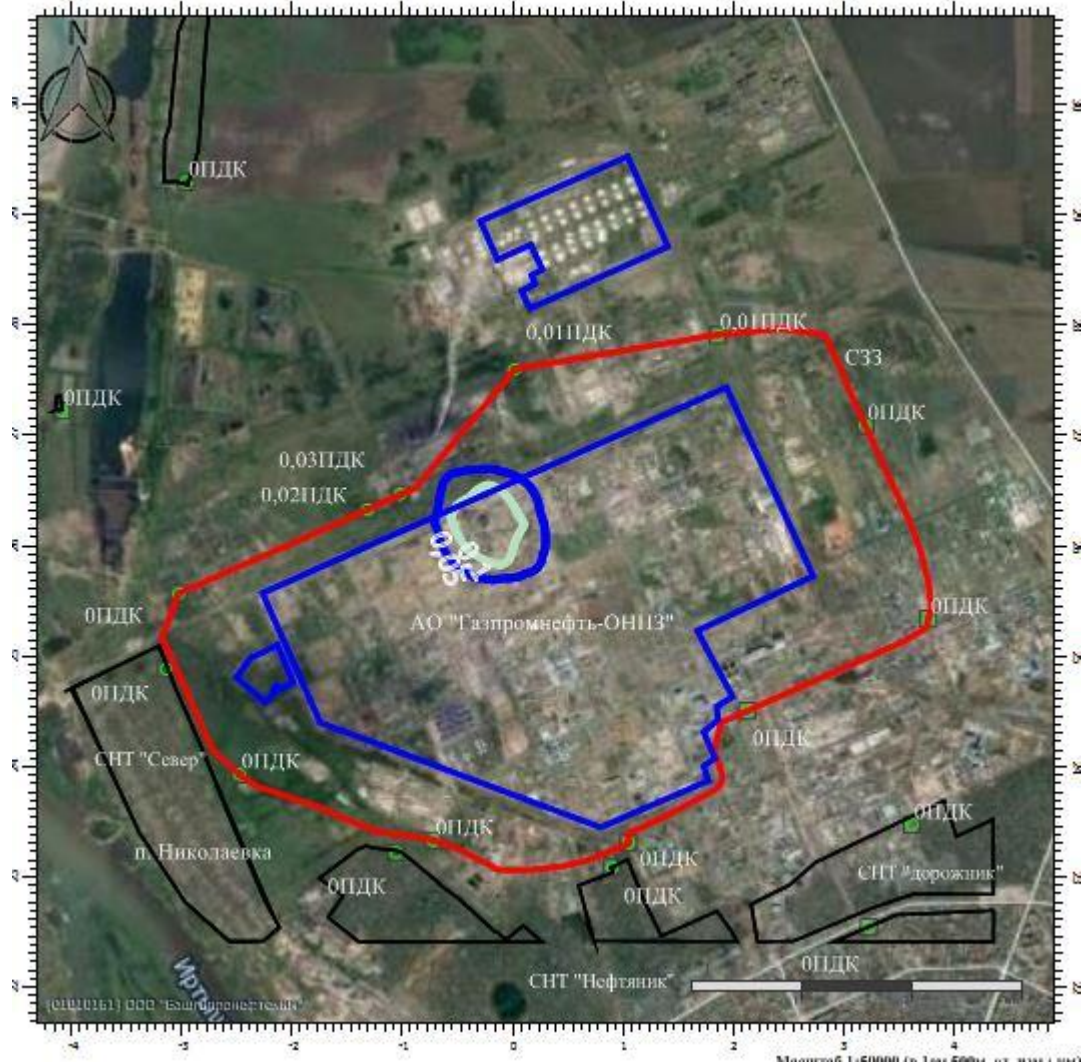
Рисунок 6.1.39 - Карта-схема расчетного загрязнения воздушного бассейна выбросами взвешенных веществ от источников АО «Газпромнефть-ОНПЗ» с учетом проведения строительного-монтажных работ
