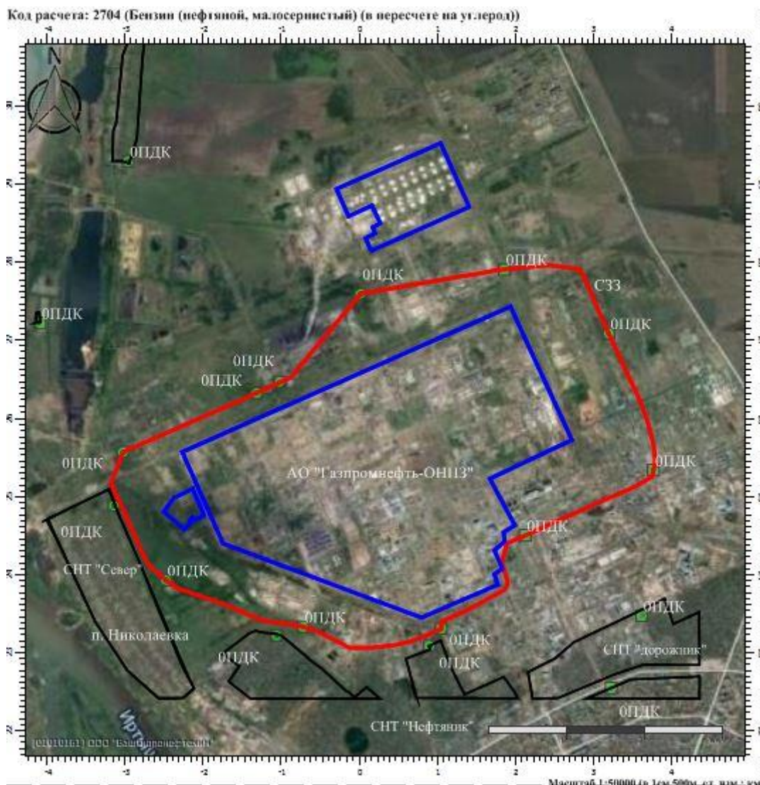
Рисунок 6.1.35 - Карта-схема расчетного загрязнения воздушного бассейна выбросами бензина нефтяного от источников АО «Газпромнефть-ОНПЗ» с учетом проведения строительно-монтажных работ
