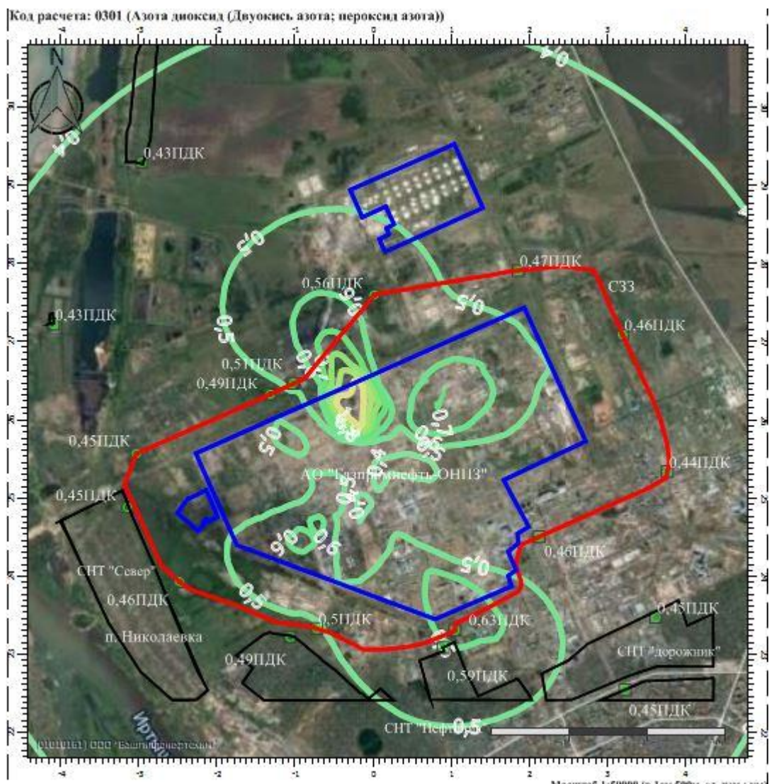
Рисунок 6.1.18 - Карта-схема расчета рассеивания азота диоксида от источников АО «Газпромнефть-ОНПЗ» с учетом проведения строительно-монтажных работ
