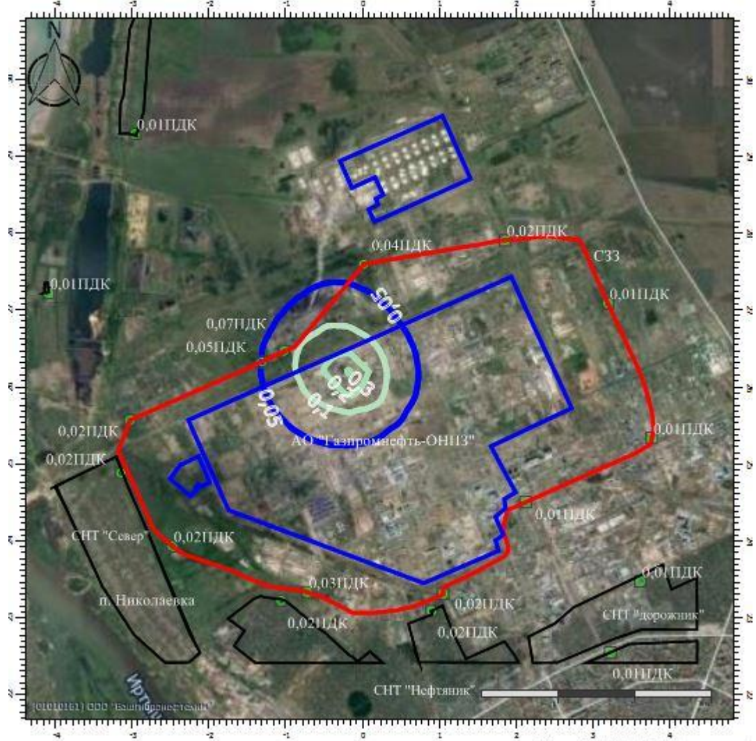
Рисунок 6.1.20 - Карта-схема расчета рассеивания углерода (пигмент черный) от источников АО «Газпромнефть-ОНПЗ» с учетом проведения строительно-монтажных работ
