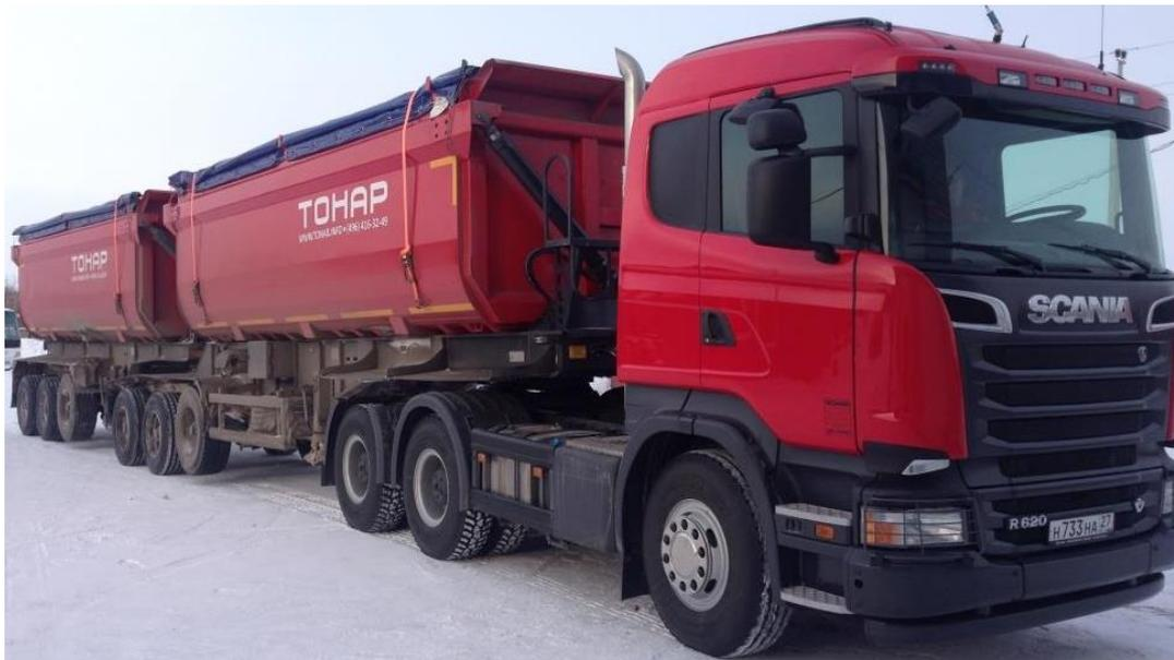
Полная масса автопоезда 137 тн. Нагрузка на ось – 18 тн.
