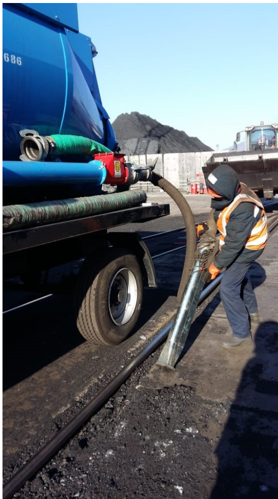
Рисунок 5.1-5. Очистка площадки выгрузки угля мобильной вакуумной установкой BlowVag Conic 3200 D
