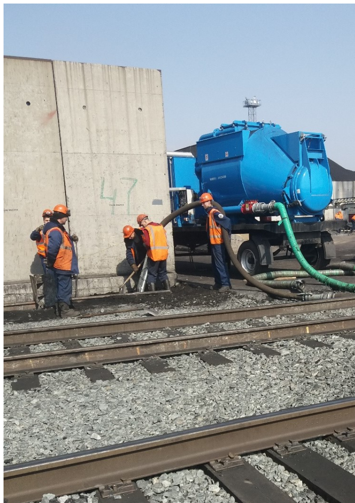
Рисунок 5.1-5. Очистка площадки выгрузки угля мобильной вакуумной установкой BlowVag Conic 3200 D
