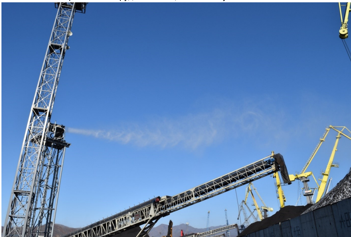
Рисунок 5.1-7. Защитный кожух на телескопическом ленточном конвейере Telestak-850 (вид с боку)
