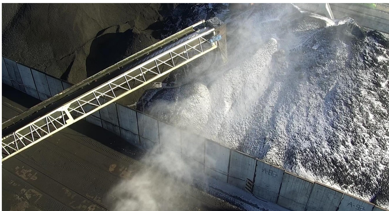
Рисунок 5.1-10. Работа одной установки пылеподавления в районе ленточного конвейера зимний период
