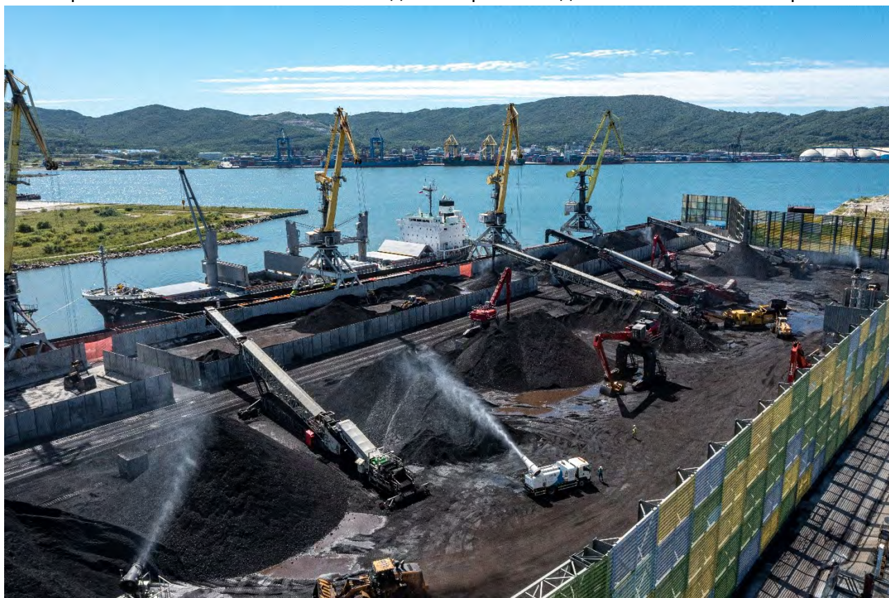
Рисунок 1.1-7. Ленточные конвейеры обеспечивают перемещение угля со склада на склад
