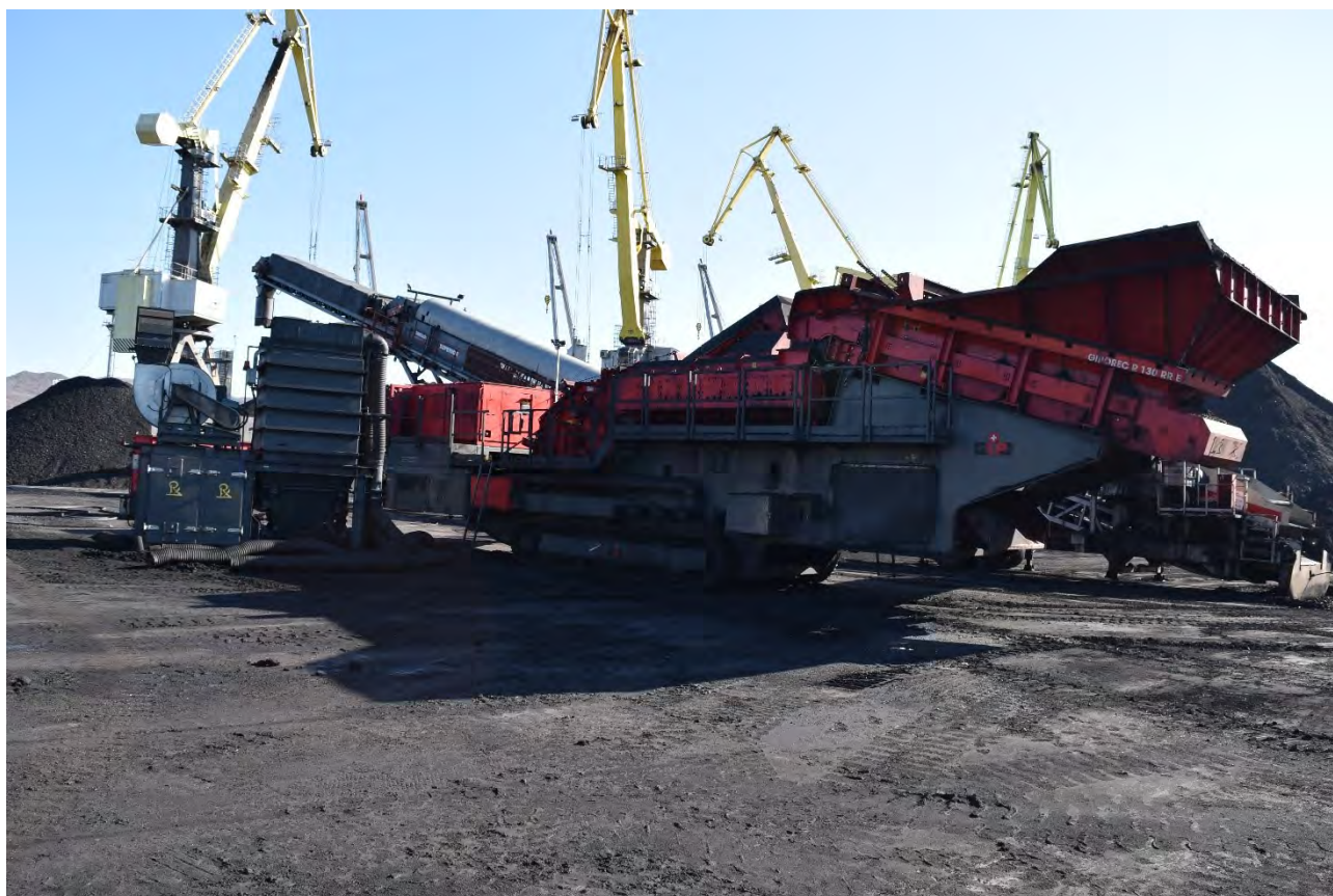
Рисунок 4.6-5. Сортировочная установка с системой аспирации пыли
