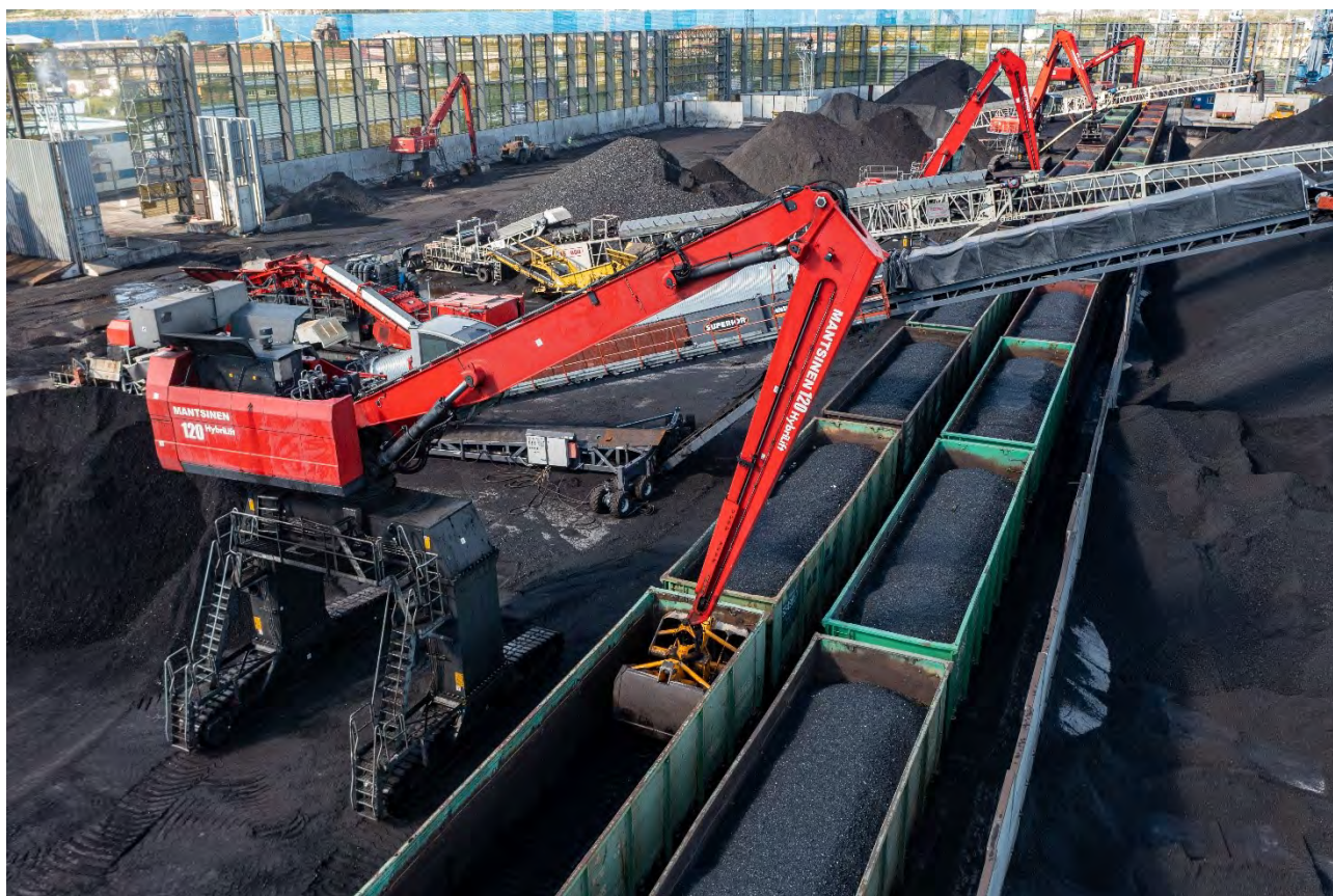
Рисунок 1.1-3. Выгрузка угля из вагонов грейферными манипуляторами
