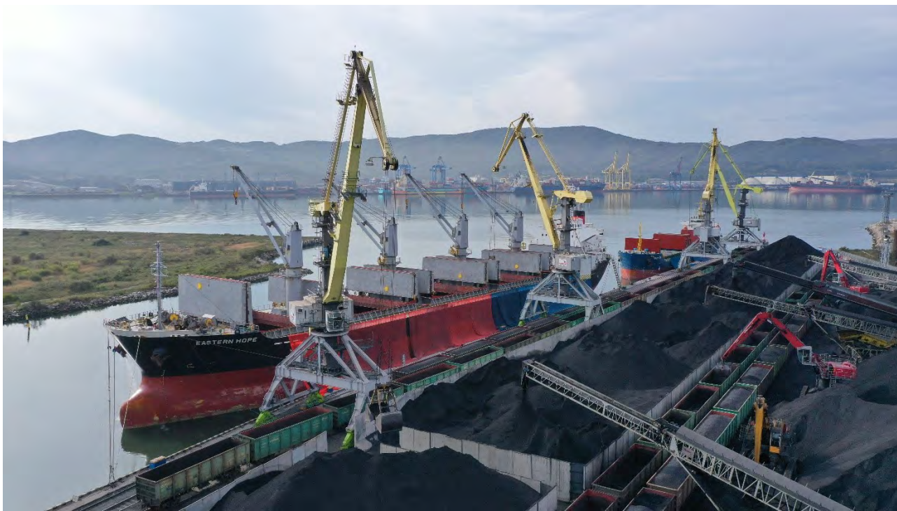
Рисунок 1.1-9. Погрузка морского судна портальными кранами грейферным способом
