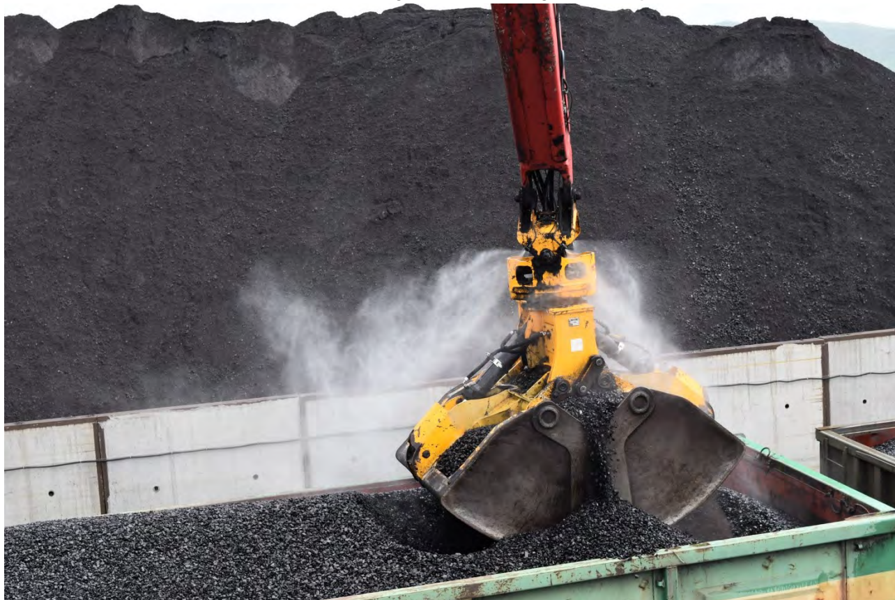
Рисунок 4.6-4. Система пылеподавления на грейфере манипулятора.
