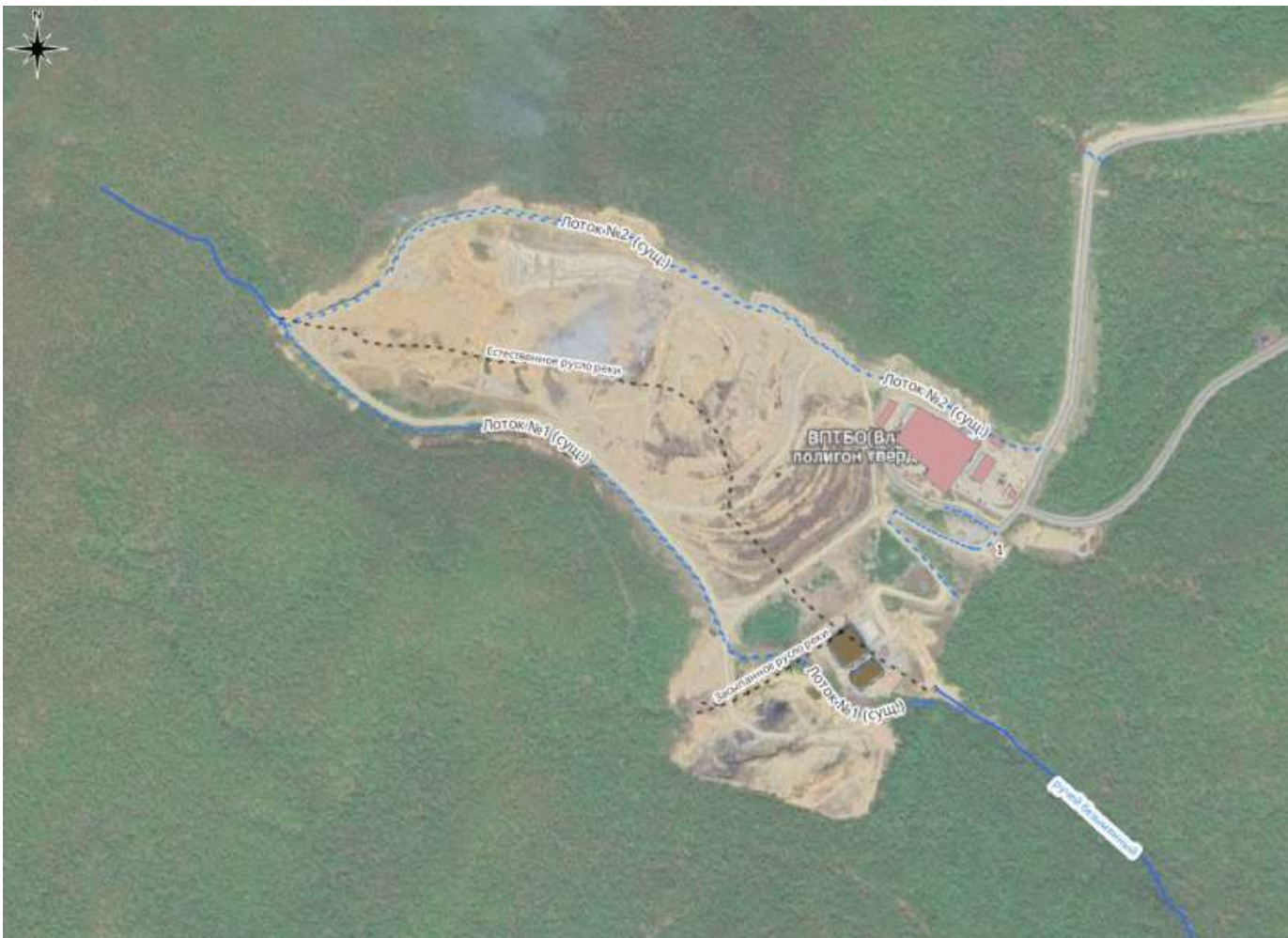
Рисунок 4.7.1 – Схема водоотведения ручья Безымянный с полигона
