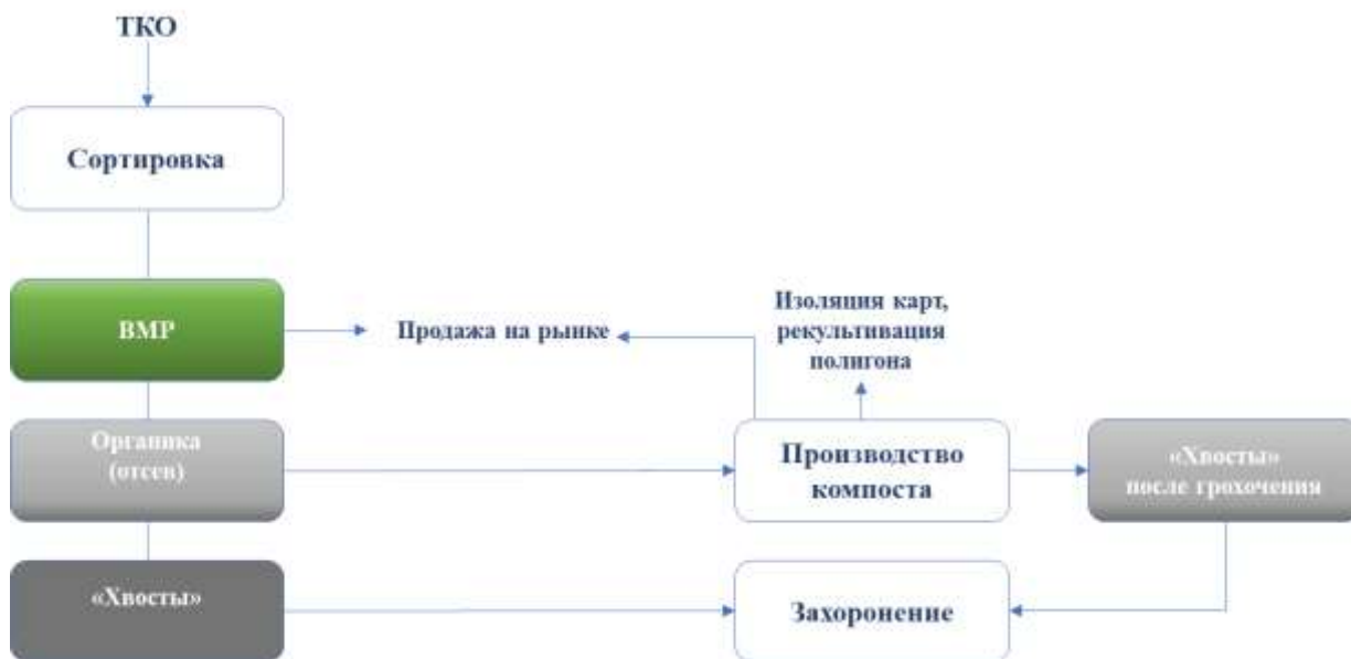
Рисунок 2.1 – Схема основных производственных процессов цеха сортировки отходов
