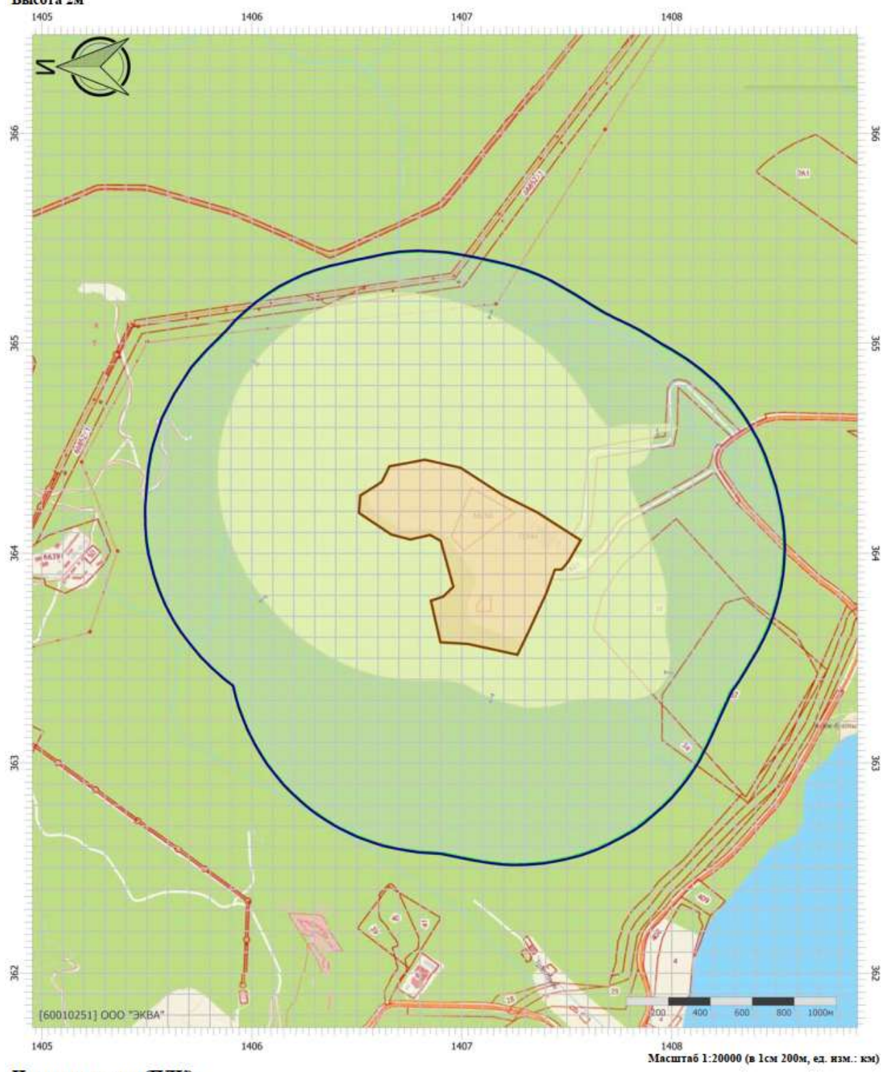
Рисунок 4.2 - Схема зоны загрязнения объекта после рекультивации с учетом реконструкции (1 ПДК)
