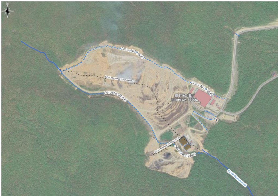
Рис.3.5. Схема водоотведения ручья Безымянный с полигона
