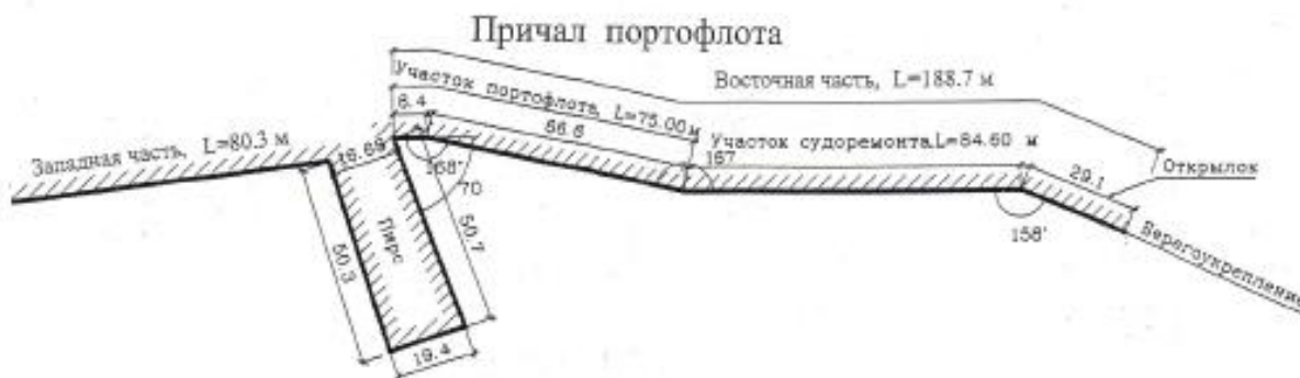
Рисунок 2.2.3 – Ситуационный план расположения существующих сооружений
