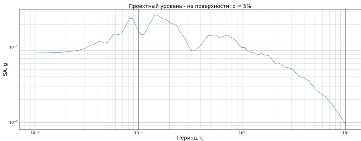
Рисунок 8.4 – Спектр реакции (затухание 5%) при периоде повторяемости 1000 лет. СГМ-3.
