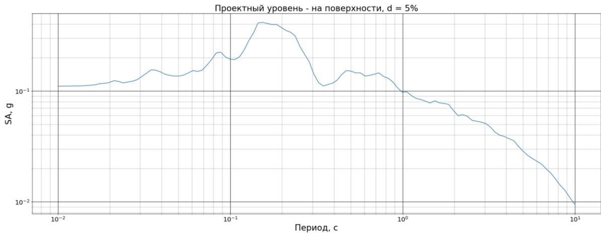
Рисунок 8.2 – Спектр реакции (затухание 5%) при периоде повторяемости 1000 лет. СГМ-1.
