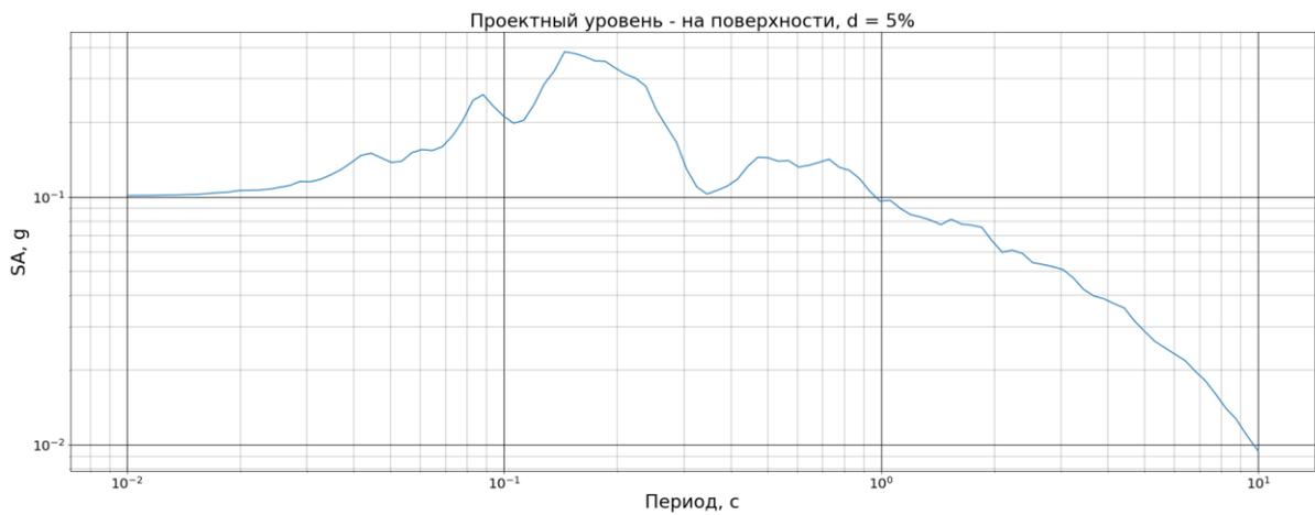
Рисунок 8.3 – Спектр реакции (затухание 5%) при периоде повторяемости 1000 лет. СГМ-2.
