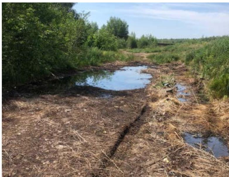
Фото 3- поверхностный выход фильтрата в районе скважины 7
