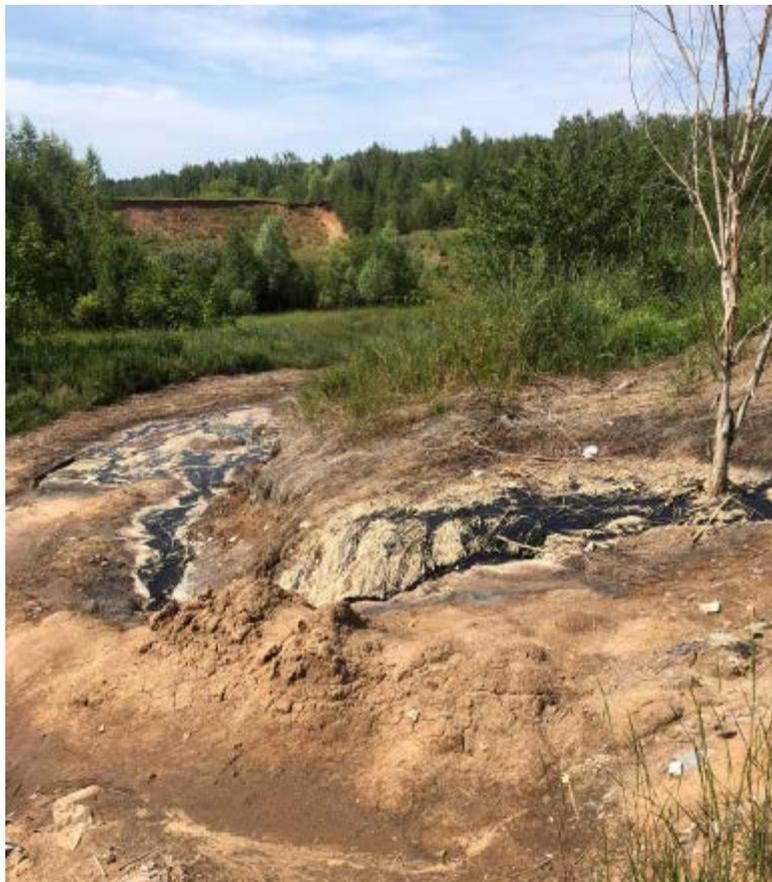
Фото 4- Выход фильтрата на поверхность в районе скважин 9 и 10
