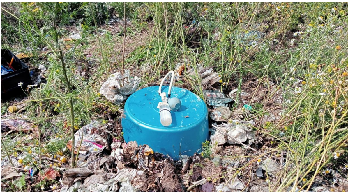
Рисунок 3.1 – Измерение эмиссии биогаза из грунтового массива в атмосферу.
