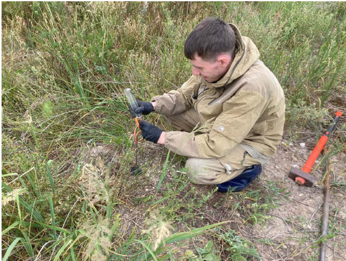
Рисунок 4.2 – Отбор газовой пробы грунтового воздуха из шпура
