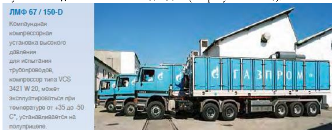
Рисунок 14 - Компрессорная установка высокого давления типа LMF 67/150-D
