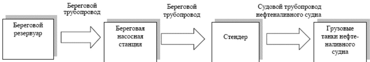
Рисунок 3.2. Технологическая схема загрузки топлива
