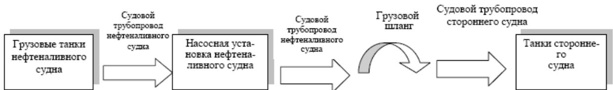
Рисунок 3.3. Технологическая схема отгрузки топлива
