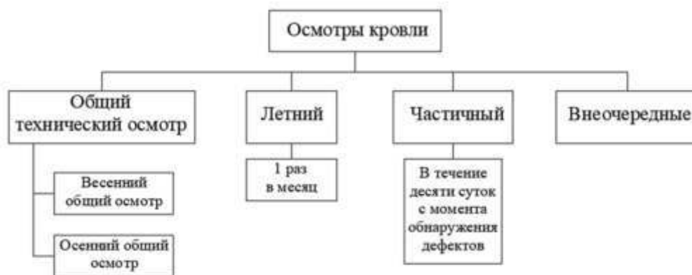
Рисунок 2 – Виды и периодичность осмотров кровли
