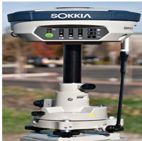
Рис. 3.1. Спутниковая аппаратура SOKKIA GRX1
