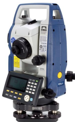
Рис. 3.3. Электронный тахеометр SOKKIA CX-105L
