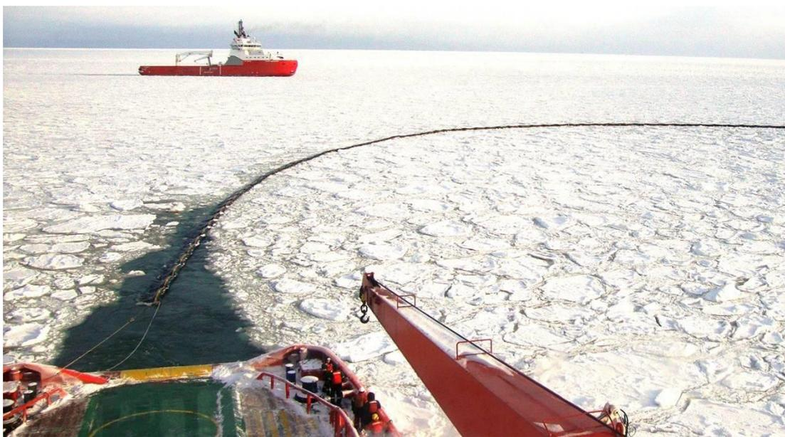
Рисунок 20 – Общий вид проведения АСР по ЛРН в ледовых условиях
