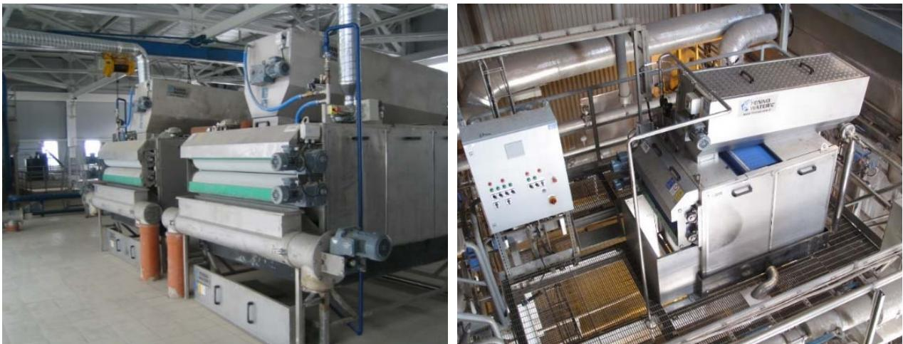
Рис. 4.6.1. Ленточные фильтр-прессы, сблокированные с барабанными сгустителями.
