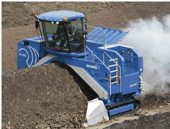
Рисунок 4.7.2.2 – Ворошитель компоста (пример)
