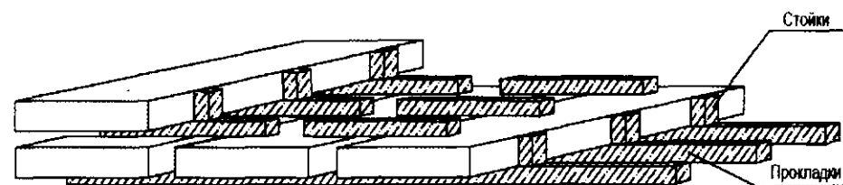
Рис.7. Укладка стальных слябов в прямоугольном трюме.
