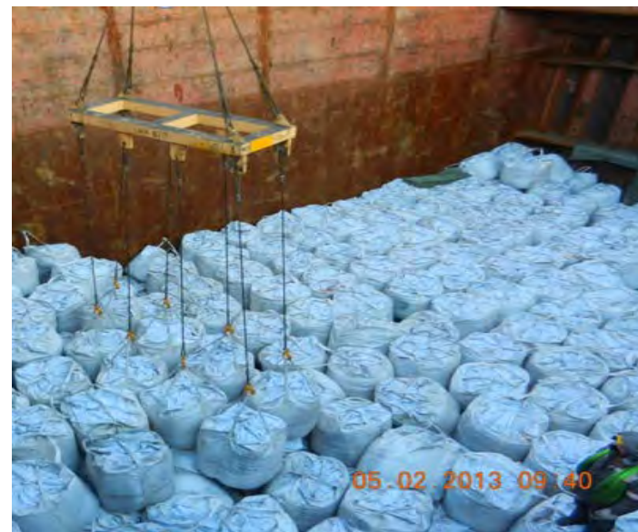
Рис.2. Застропка МК в трюме.
