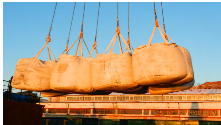
Рис.3. «Подъём» состоит из восьми МК, подъёмные проушины которых навешаны на крюки рамы.
