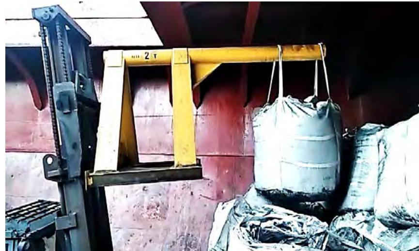
Рис. 6 Специальное приспособление на грузовой раме а/п.
