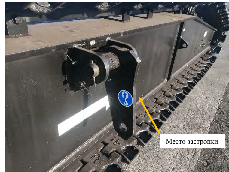
Рис. 2 Место застропки рамы гусеничного хода крана.
