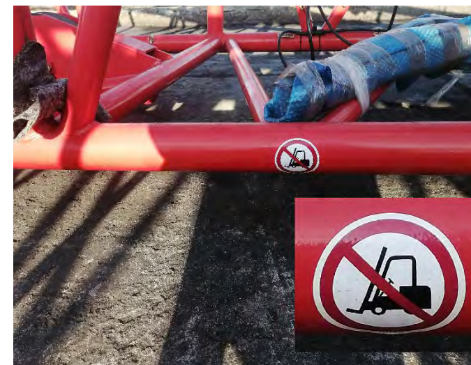
Рис. 3 Знак запрещающий подъём с помощью а/п.
