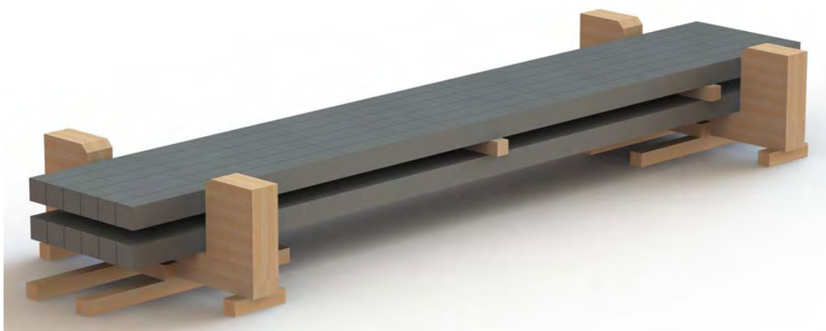
Рис.12 Формирование многослойного подъема при погрузке заготовки сечением 150мм*150мм на просвет трюма судна
