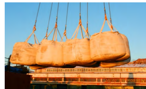
Рис.3 «Подъём» состоит из восьми МК, грузоподъёмные проушины которых навешены на крюки рамы.
