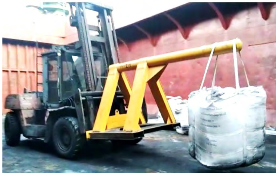
Рис. 7 Перемещение МК при помощи специального приспособления.
