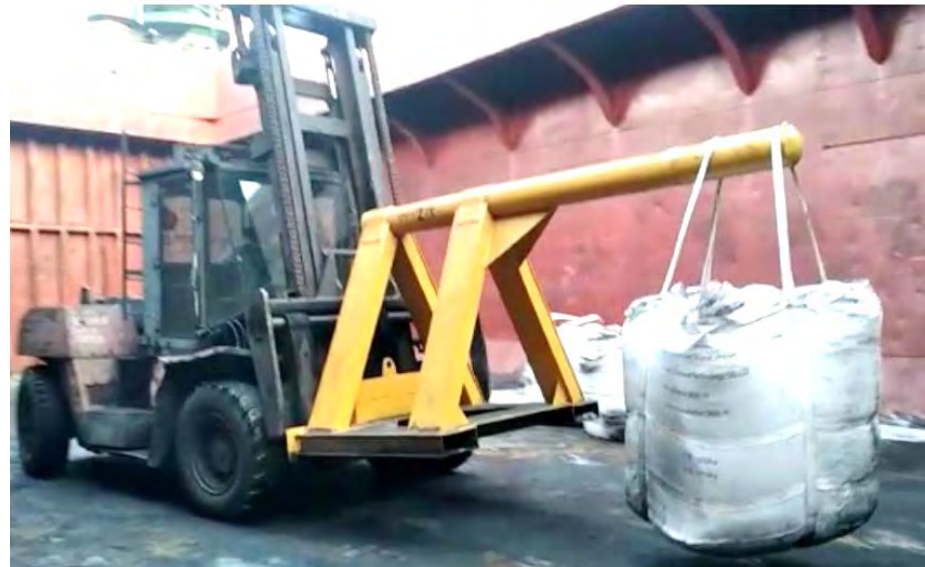
Рис. 7 Перемещение МК при помощи специального приспособления.
