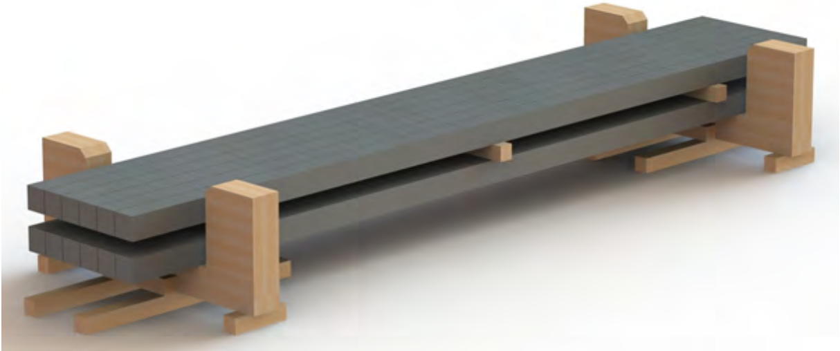
Рис.12 Формирование многослойного подъема при погрузке заготовки сечением 150мм*150мм на просвет трюма судна
