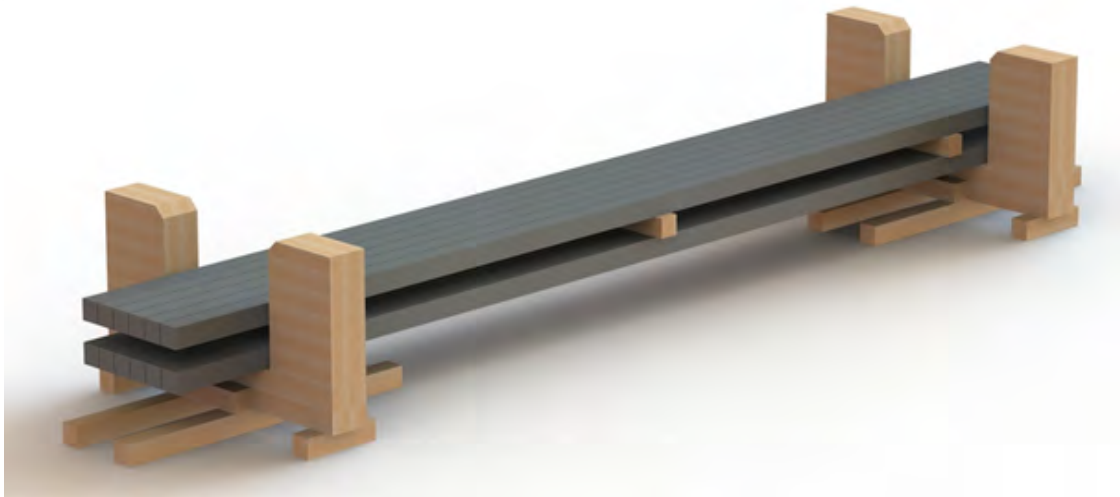
Рис.11 Формирование многослойного подъема при погрузке заготовки в подпалубное пространство
