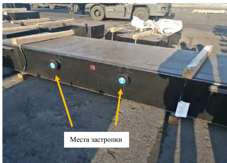
Рис. 1 Места застропки неупакованного узла кранового противовеса.
