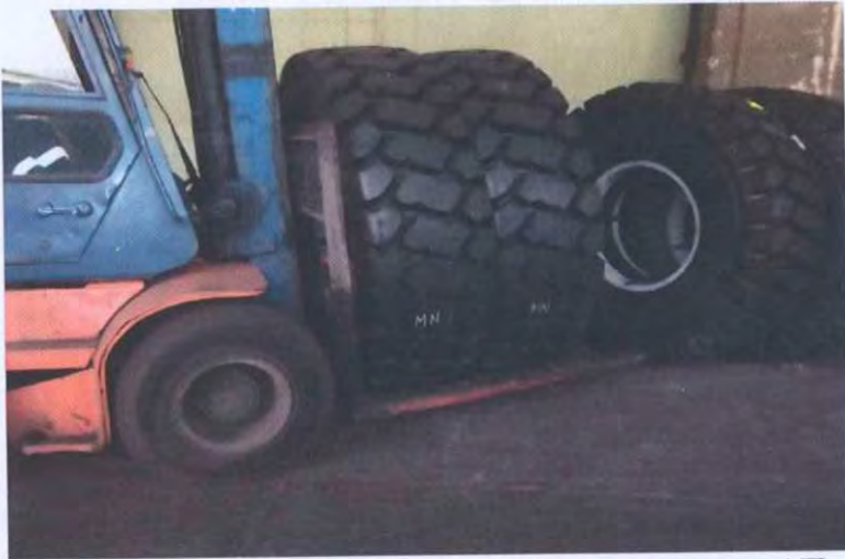
Рис.5. Захват шин под образующую при помощи АП оборудованного вилочным захватом
