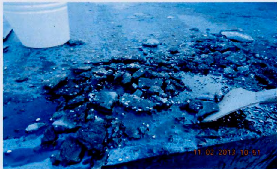
Рис.2. Равномерное нанесение слоя реагента на стальной сляб и дальнейшая очистка сляба от наледи.
