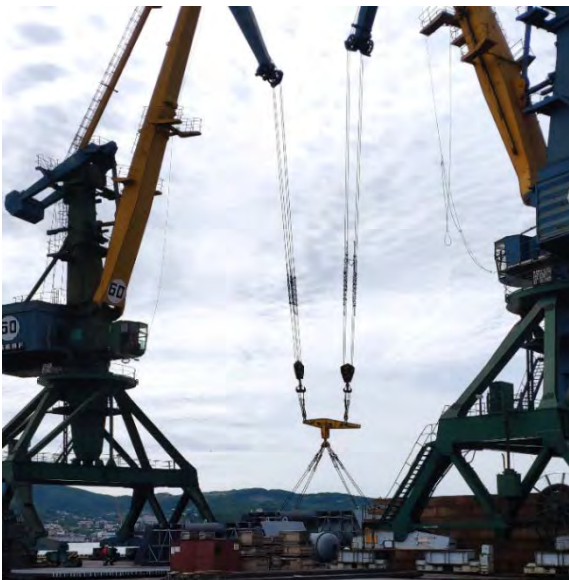
Рис. 12 Работа кранов с балансиром БСК-80
