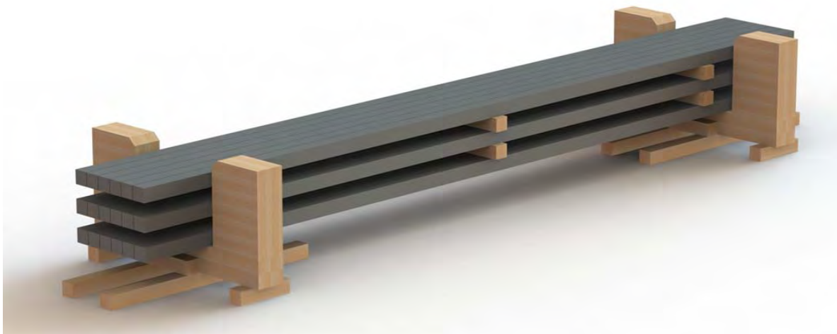
Рис.13 Формирование многослойного подъема при погрузке заготовки сечением 100мм*100мм на просвет трюма судна
