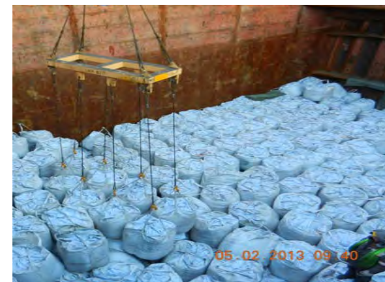
Рис.2 Застропка МК в трюме.
