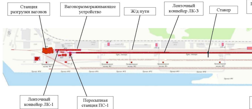
Рисунок 3.4 – Общее устройство портового перегрузочного комплекса
