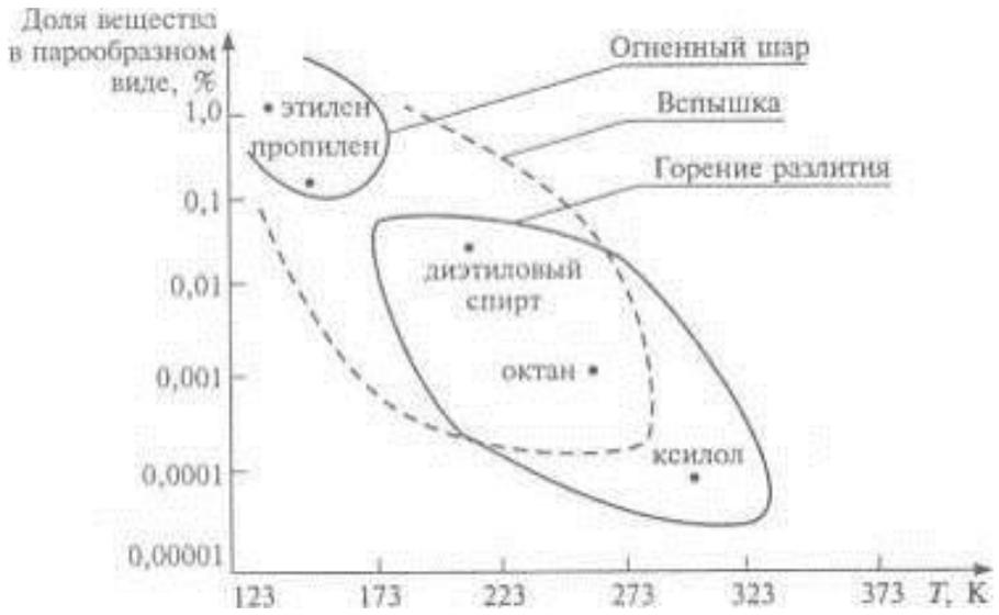
Рисунок 5 - Зависимость характеристик пожара от температуры кипения вещества
