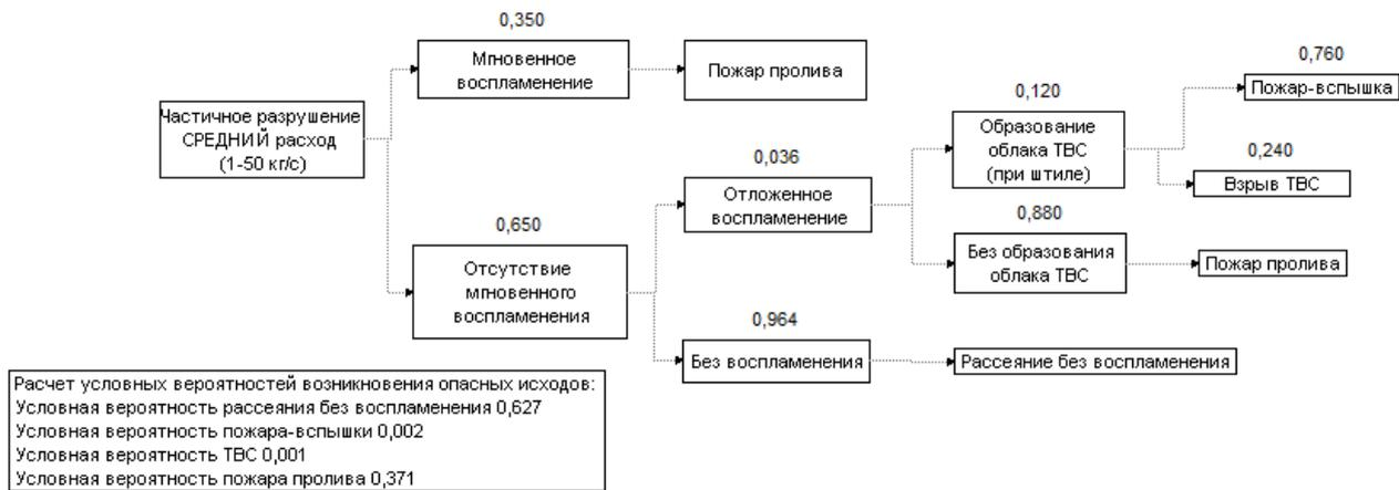
Рисунок 3 - Дерево событий для частичного разрушения оборудования, содержащего нефтегазовую смесь
