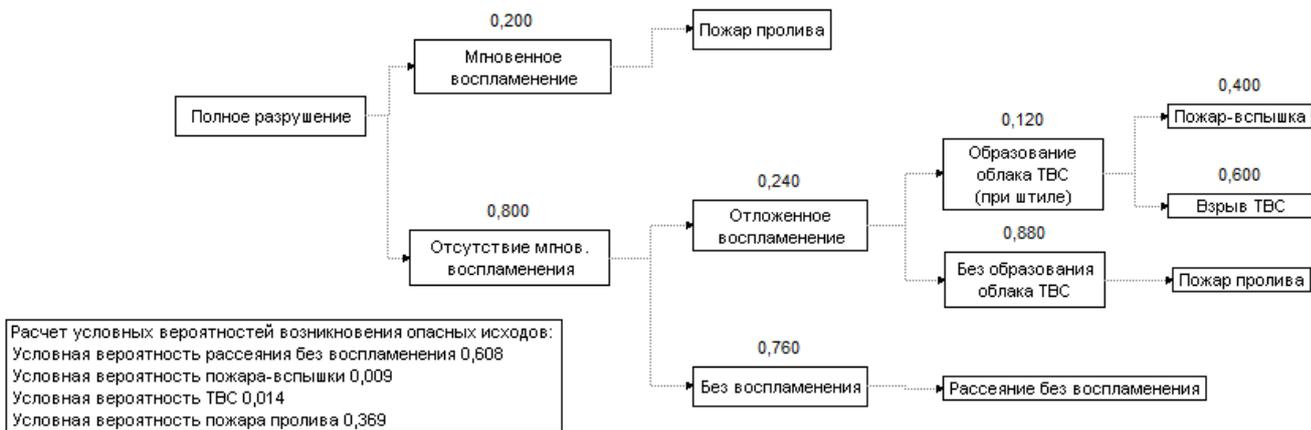
Рисунок 4 - Дерево событий для полного разрушения оборудования, содержащего нефтегазовую смесь
