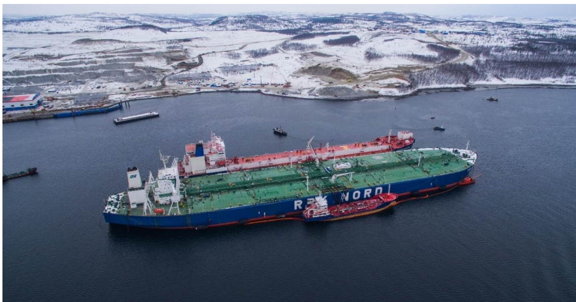
Рисунок 3.11. Перевалка нефти с борта танкера «Штурман Щербинин» на РПК «Норд» в Кольском заливе
