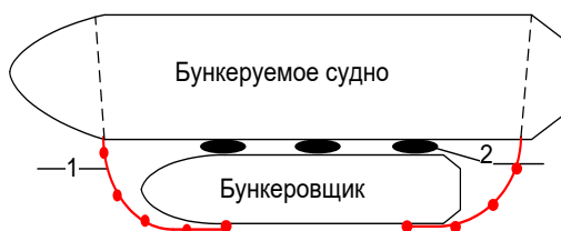
Рисунок 3.8. Ограждение боными судов при бункеровке в акватории
