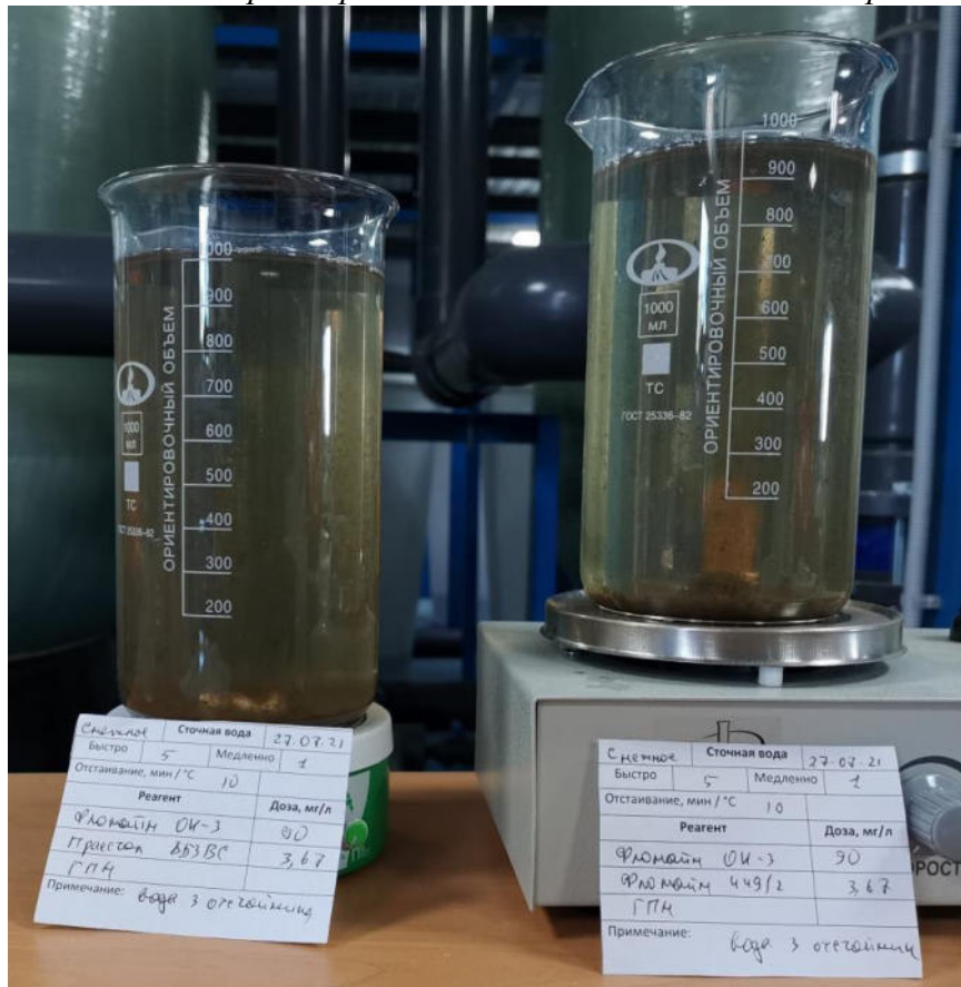
Рис. 2. Осветленная вода из третьего отстойника по схеме:
