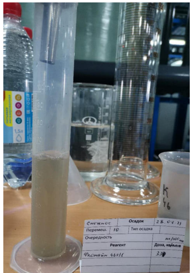
Рис. 6. Результат обезвоживания биологического осадка флокулянтom Фломайн 465/2 (на фото ошибка) с примерной дозой 6,6 кг/т.с.в.
