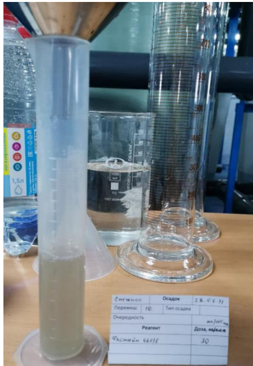
Рис. 5. Результат обезвоживания биологического осадка флокулянтom Фломайн 465/2 (на фото ошибка) с примерной дозой 6 кг/т.с.в.
