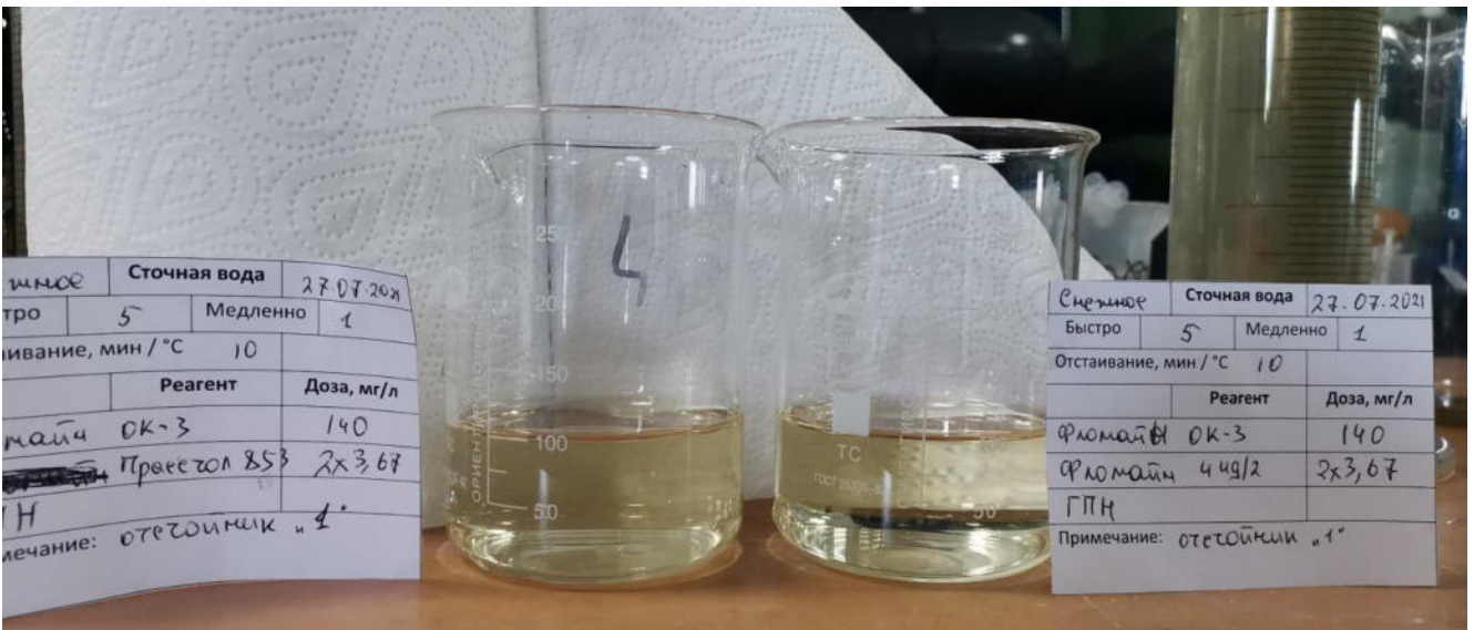
Рис. 1. Осветленная вода из первого отстойника (наиболее загрязненная вода) по схеме: добавление коагулянта Фломайн ОК-3 с дозой 140 мг/л; умеренное перемешивание в течение 5 минут; добавление флокулянта Праестол 853ВС (слева) или Фломайн 449/2 (справа) с дозой 7,34 мг/л; медленное перемешивание в течение 1 сек; отстаивание в течение 10 минут фильтрация, замер скорости фильтрации 100мл фильтрата: Праестол 853 ВС – 4 мин 20 сек; Фломайн 449/2 – 3 мин 15 сек
