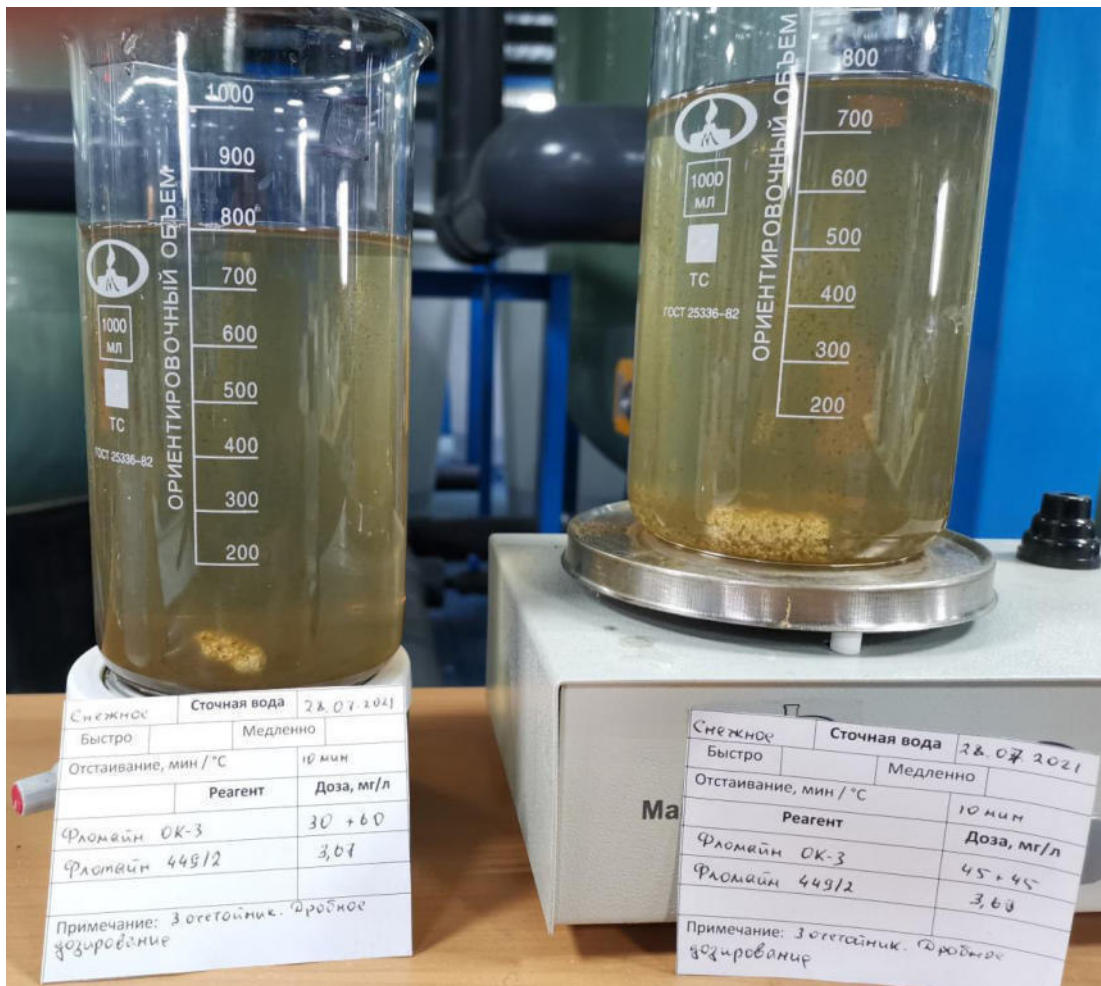
Рис. 3. Осветленная вода из третьего отстойника по схеме:
