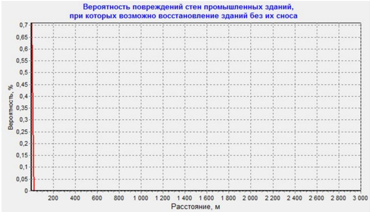
Вероятность повреждений стен промышленных зданий, при которых возможно восстановление зданий без их сноса при взрыве на ГПСД
