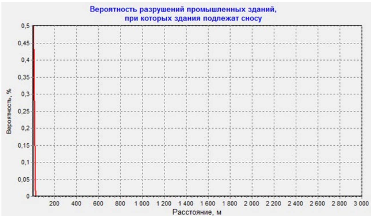
Вероятность разрушений промышленных зданий, при которых здания подлежат сносу при взрыве на ГПСД
