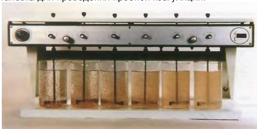
Рисунок 1 - Лабораторная установка для пробной коагуляции
