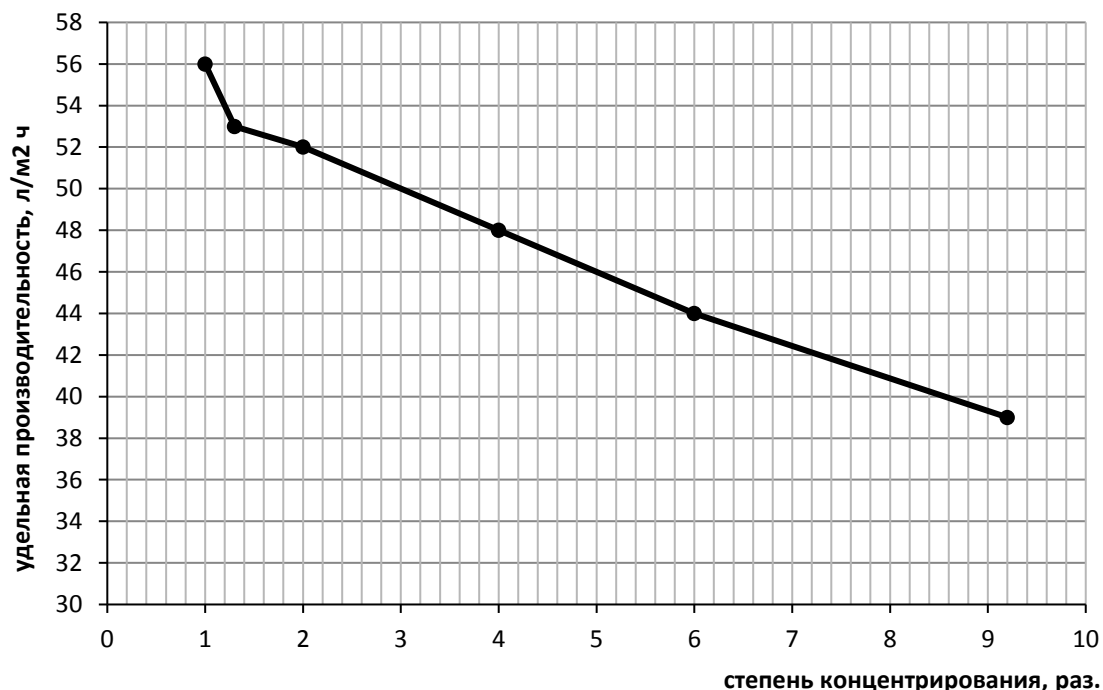
Рисунок 8 - Зависимость производительности мембраны на 3-й ступени от степени концентрирования
