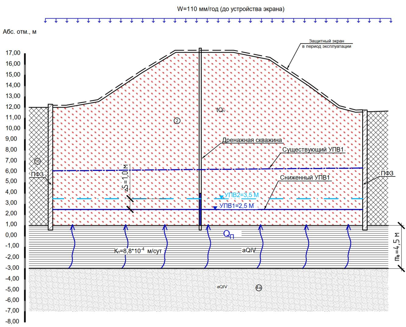
Рис. 4.3 – Фильтрационная схема для определения притока к дренажным скважинам
