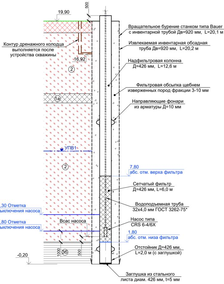
Примечание - Для защиты металла от воздействия щелочей водоприемную часть фильтровой колонны и все металлические элементы оголовков дренажных скважин обработать эпоксидной Эмалью ЭП-773 (или аналог) в два слоя.
