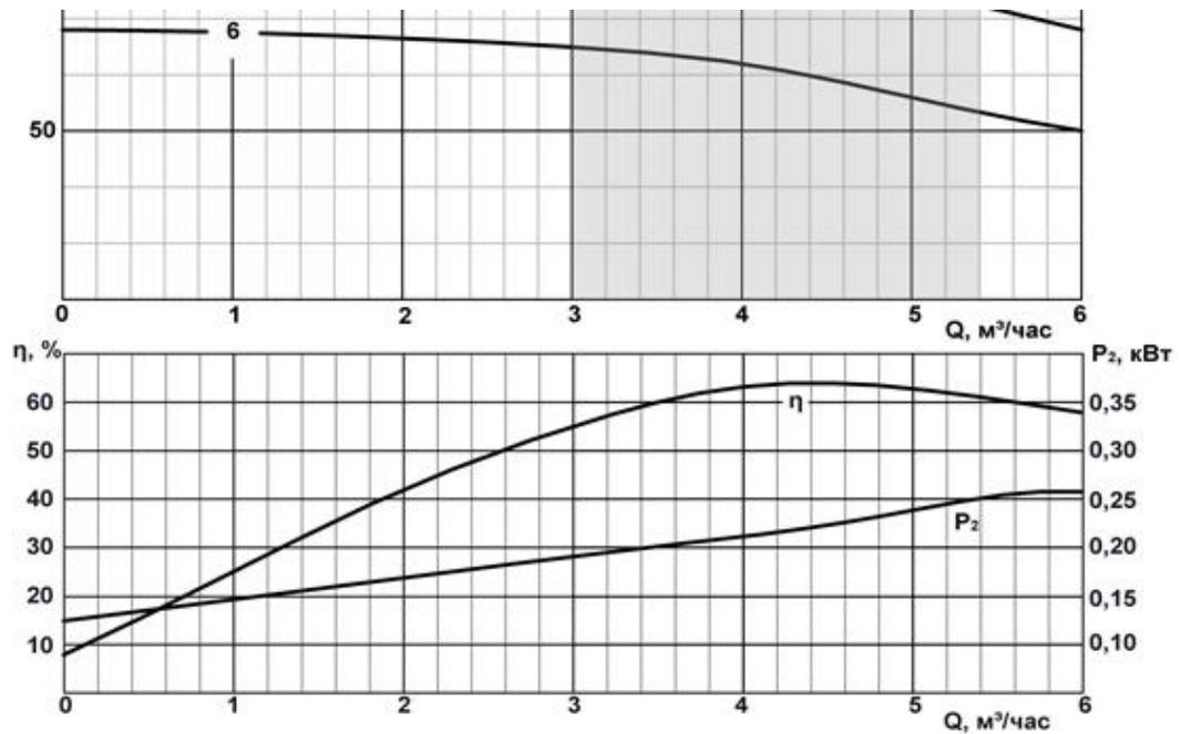
Рис. 4.4 – Напорно-расходная характеристика насосов CRS 6-4/6X (АО «Ливнынасос»)
