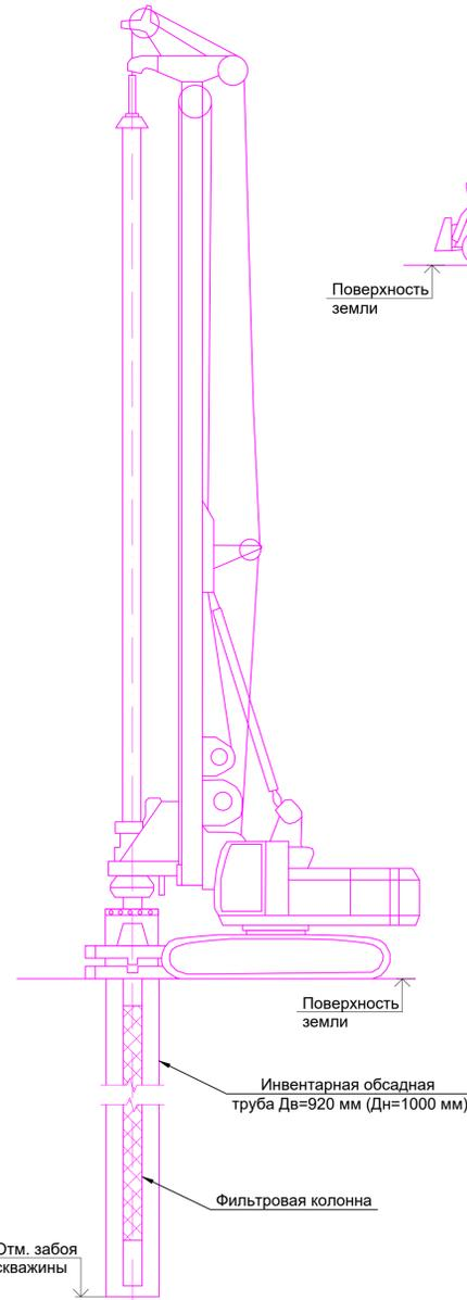
3. Устройство обсыпки скважины экскаватором "Беларусь" с емкостью ковша 0,15 м³
