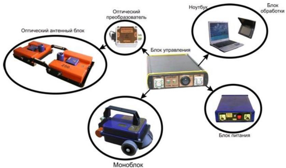
Рисунок 4.3-13. Функциональная схема георадара с блоком управления
