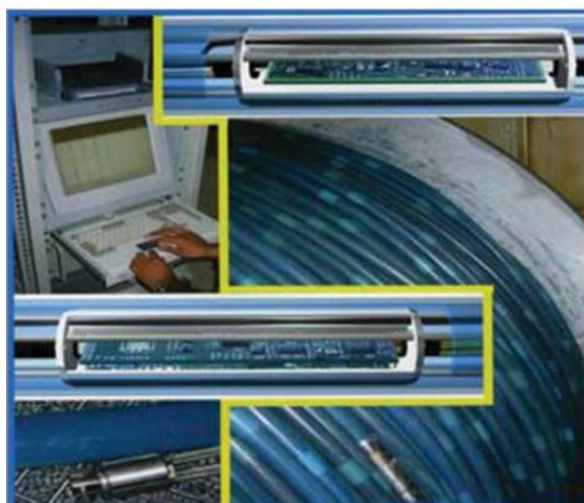
Рисунок 4.3-9. Российская 192-канальная цифровая коса модели XZoneBottomFish производства компании «Си Технолоджи Инструмент»
