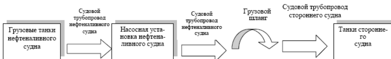
Рисунок 4.4. Технологическая схема отгрузки топлива
