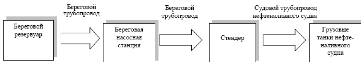
Рисунок 4.3. Технологическая схема загрузки топлива
