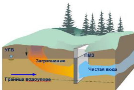
Рисунок 1. Схематичное изображение противомиграционной завесы
