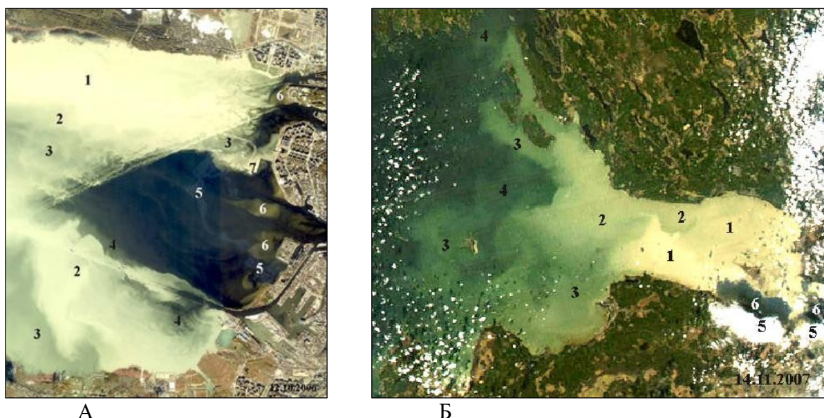
Рис. 26. А - Повышение концентрации взвеси в воде после начала работ по строительству «Морского фасада» [5-20]. 12.10.2006 г., IKONOS. Условные обозначения: 1 – очень высокие значения концентраций взвешенных осадков, 2 – высокие значения концентраций взвешенных осадков, 3 – средние значения концентраций взвешенных осадков, 4 – низкие значения концентраций взвешенных осадков, 5 – нефтяные пленки, 6 – отмели и мели, 7 – строящийся причал. Б - Загрязнение акватории Невской губы и восточной части Финского залива взвешенными веществами по данным Aqua/MODIS за 14 ноября 2007 г.: 1 – максимальные значения концентраций взвеси; 2 – высокие значения концентраций взвеси; 3 – средние значения концентраций взвеси; 4 – низкие значения концентраций взвеси; 5 – облака; 6 – тени от облаков [VI-20].
