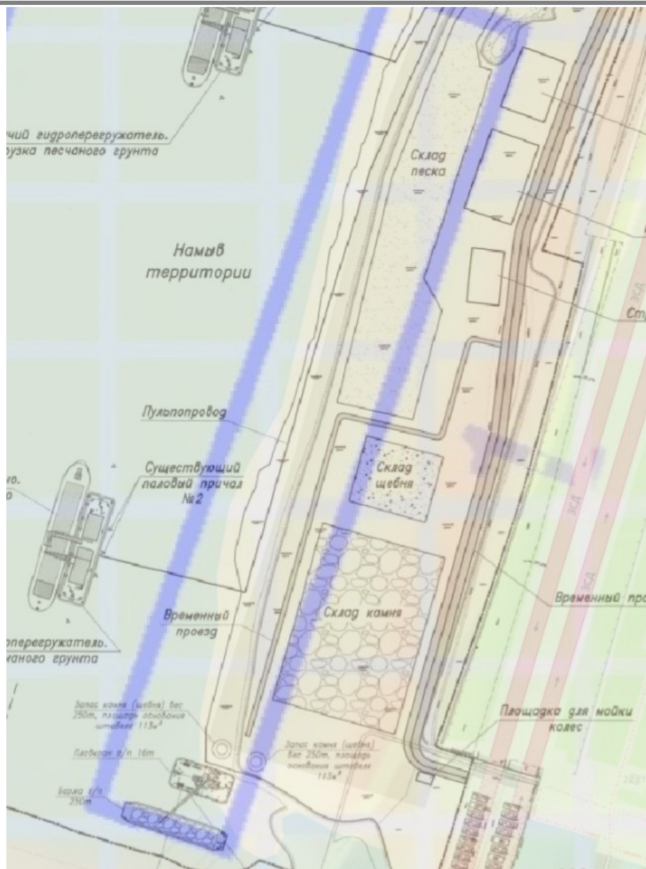
Рис. 22. Принт-скрин части строительного генерального плана. (лист 8 графических материалов, том 6.1). Синим цветом обозначен источник выбросов загрязняющих веществ в атмосферный воздух № 6007 «Заправка строительной техники» по данным проекта (стр.235, раздел 9.4.2, том 8.1.1).
