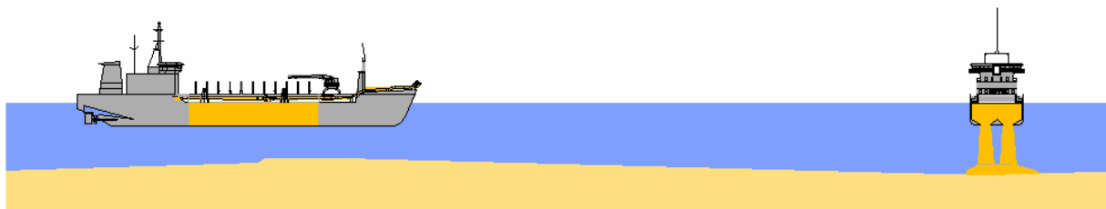
Рисунок Б.5 - Разгрузка СТЗ под воду посредством открытия днищевых дверей
