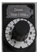
Рис. 11: Поворотный регулятор на панели управления для установки скорости барабанного грохота
