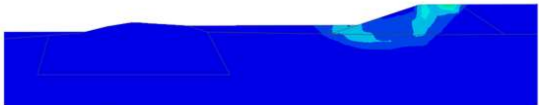
Рисунок 18 – Разрез 2-2(в), кривая обрушения, расчет №1 (по методу SRM)
