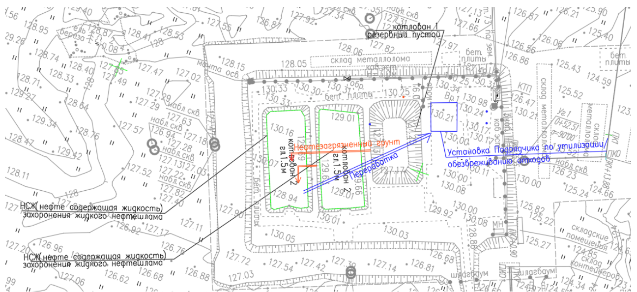
Рис.2.1 – Схема утилизации/обезвреживания нефтезагрязненного грунта
