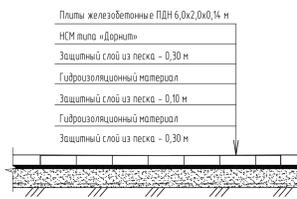
Конструкция покрытия проездов (Тип 1)
