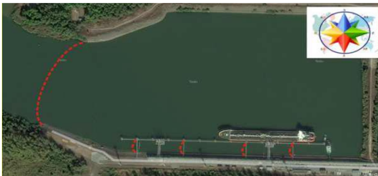
Рисунок 6.10.2 - Схема постановки оперативных боновых заграждений при выполнении сливно-наливных операций
