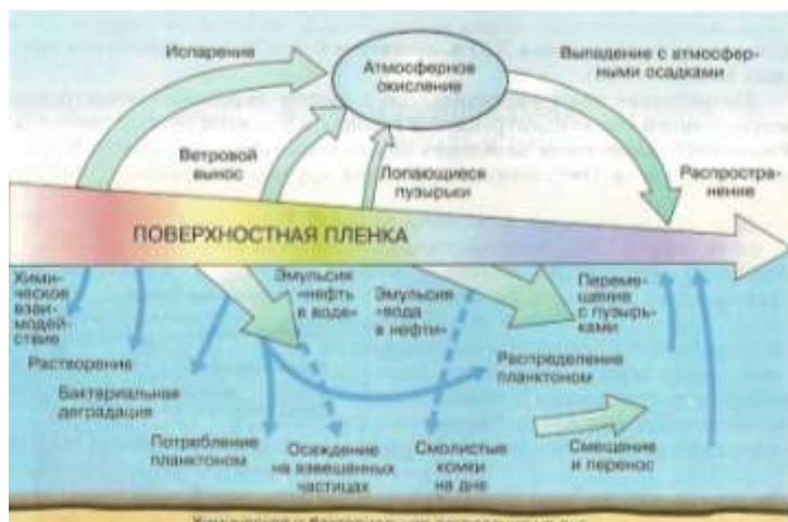
Рисунок 4.5.4 - Схема процессов распределения и разрушения нефтепродуктов, разлитых на воду
