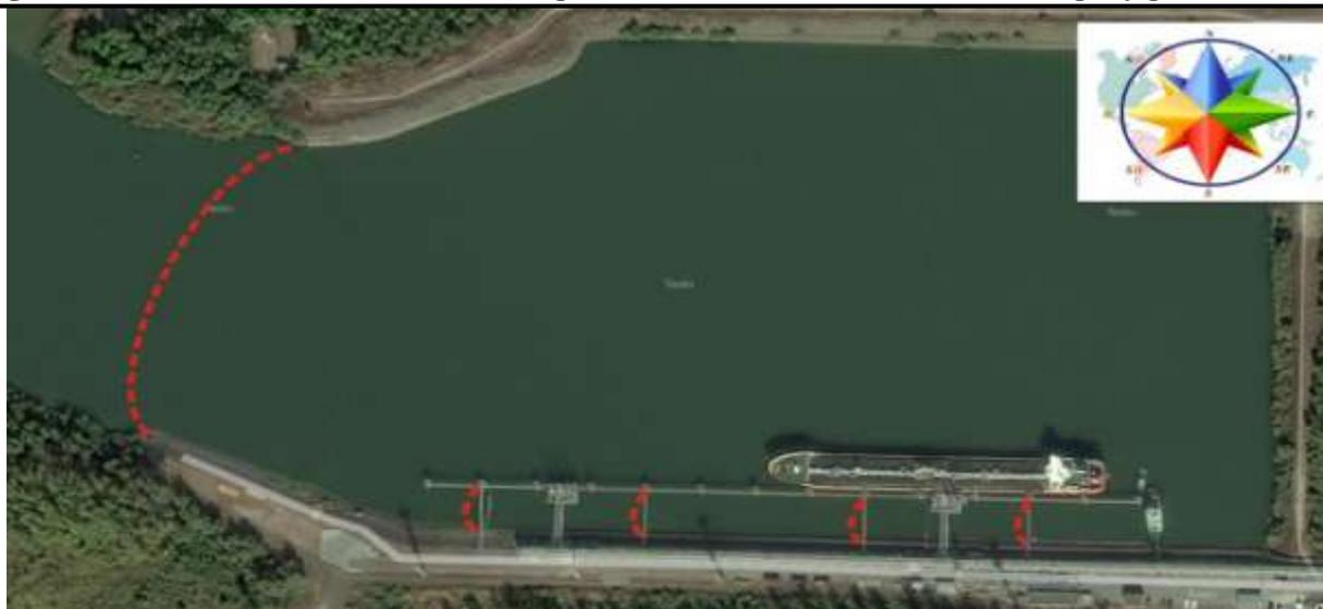
Рисунок 5.3.2 - Схема постановки оперативных боновых заграждений при выполнении сливно-наливных операций
