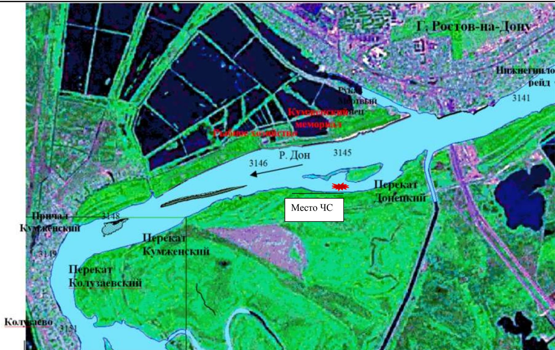
Рисунок 4.5.3 – Модель распространения нефтепродукта бензиновой группы. Разлив одномоментный. Объем разлива  $1480\text{ м}^3$  (максимальная величина разлива для нефтепродукта бензиновой группы  $1061,3\text{ т.}$ )
