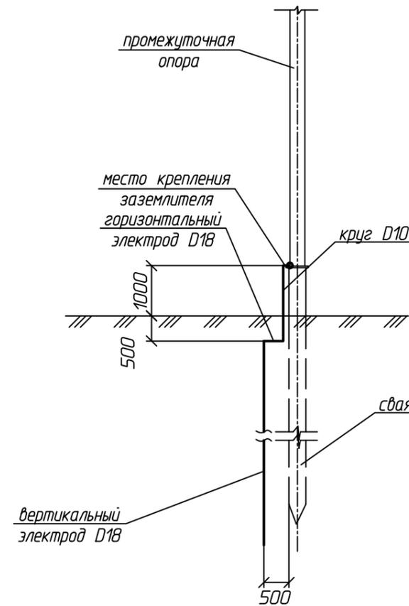
Заземляющее устройство анкерных и анкерно-угловых опор
