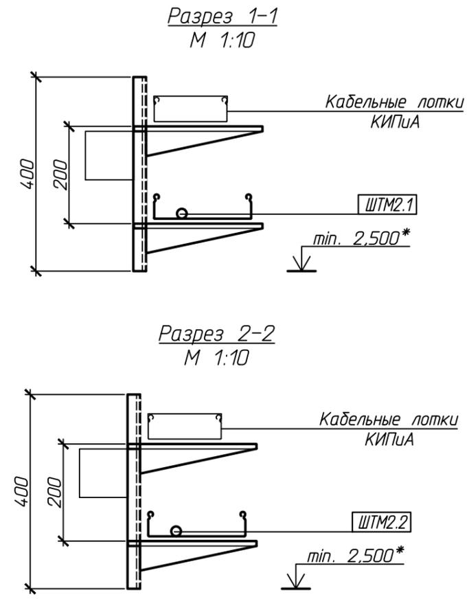
1. Опуски кабеля вдоль стоек кабельных эстакад, подходы к потребителям (задвижкам, коробкам, щитам) выполнить при необходимости в лотке, трубе, металлорукаве.
