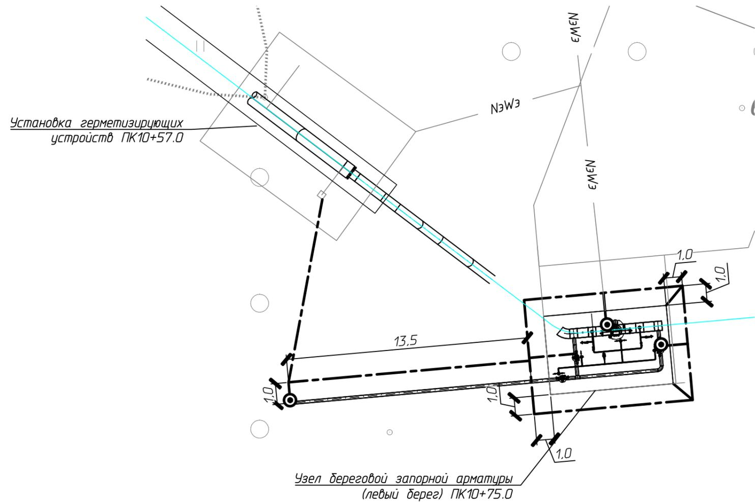
Установка герметизирующих устройств ПК10+57.0
