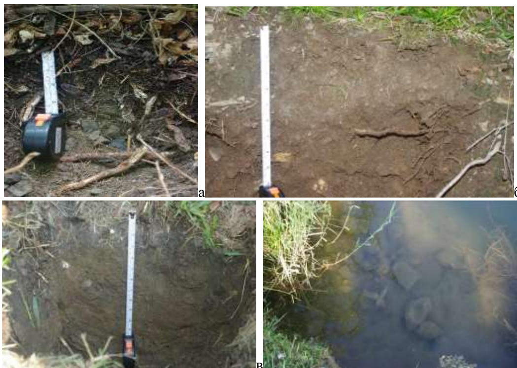
Рисунок 3.8 – Почвенные разрезы: а) техногенная почва с песком и щебнем в границах кластера № 2; б) кластер № 3; в) кластер № 7; г) техногенный грунт на дне водоема кластера № 7
