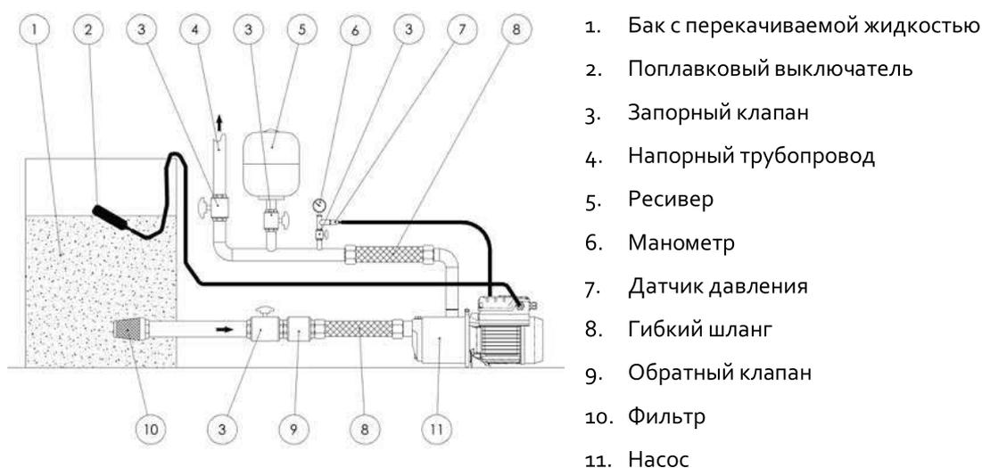
Рис. 5 Установка насоса ниже уровня жидкости
