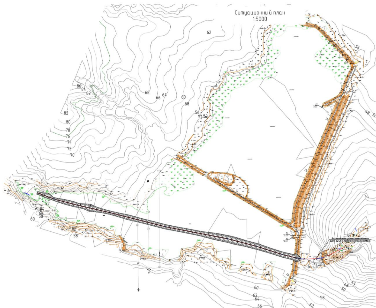
Рис 2.2.1 - Рекультивация золошлакоотвала с восстановлением русла ручья в южной секции золошлакоотвала
