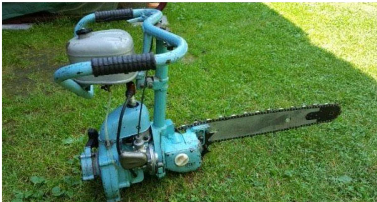
Для снижения уровня шума пила оборудована глушителем, а **уровень издаваемого шума 106 дБ**. В бензопилу Дружба 4М-Электрон установлен карбюратор КМП-100У или КМП-100-АР. Присутствуют системы автоматического торможения и смазки пильной цепи. Вес 12,5 кг.
