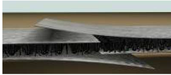
Рис. 38. Стыковка полотен дренажного геокомпозита
