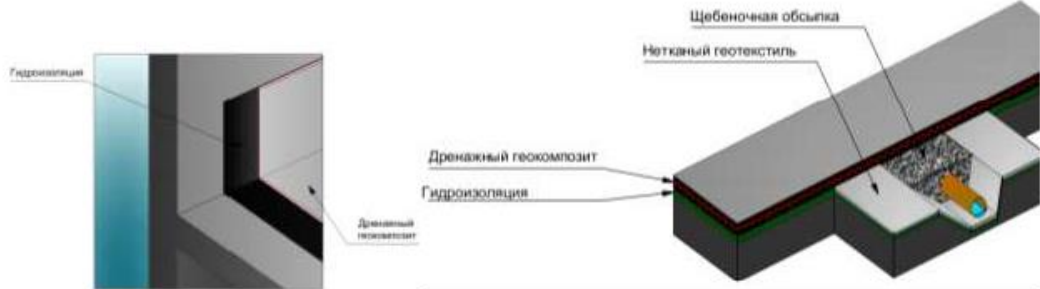
г) примыкание к стенке
