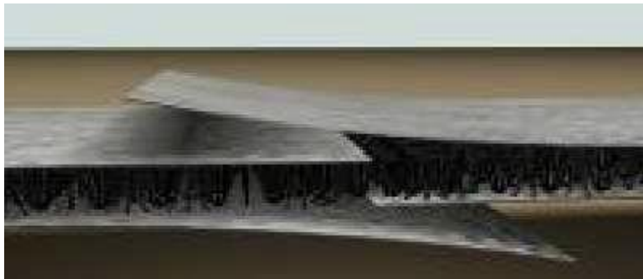
Рис. 2.6 - Стыковка полотен мата дренажного геокомпозитного 3D
