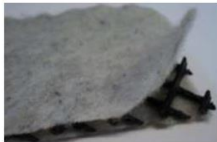
Рис. 8. Экструдированная решетка, скрепленная с двух сторон с геотекстилем
