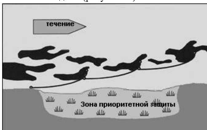
Рис. 35 – Отвод нефтяного пятна боами, установленными каскадами
