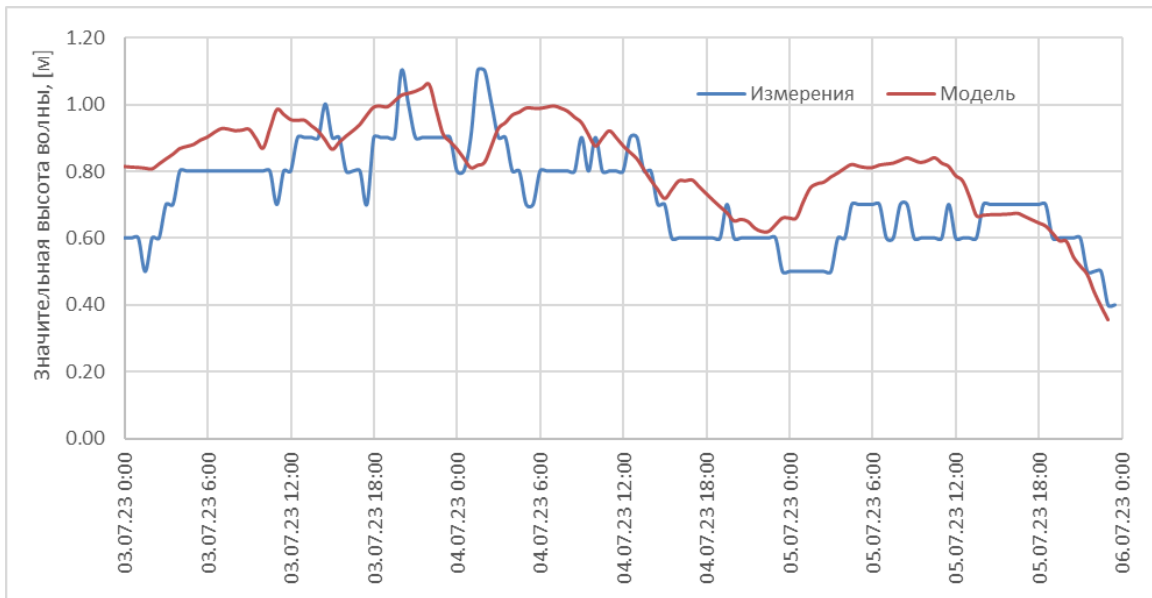
Рис.9 – Сравнение измеренной и рассчитанной средней высоты волн для зимнего периода, волновой буй «Helsinki Suomenlinna»
