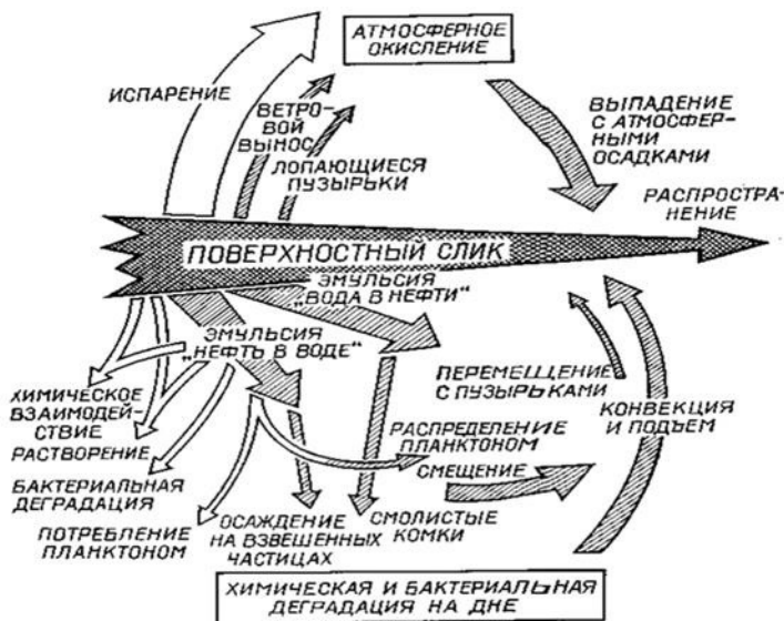
Рис. 45 – Общая диаграмма процессов распределения и разрушения в море разлитой нефти
