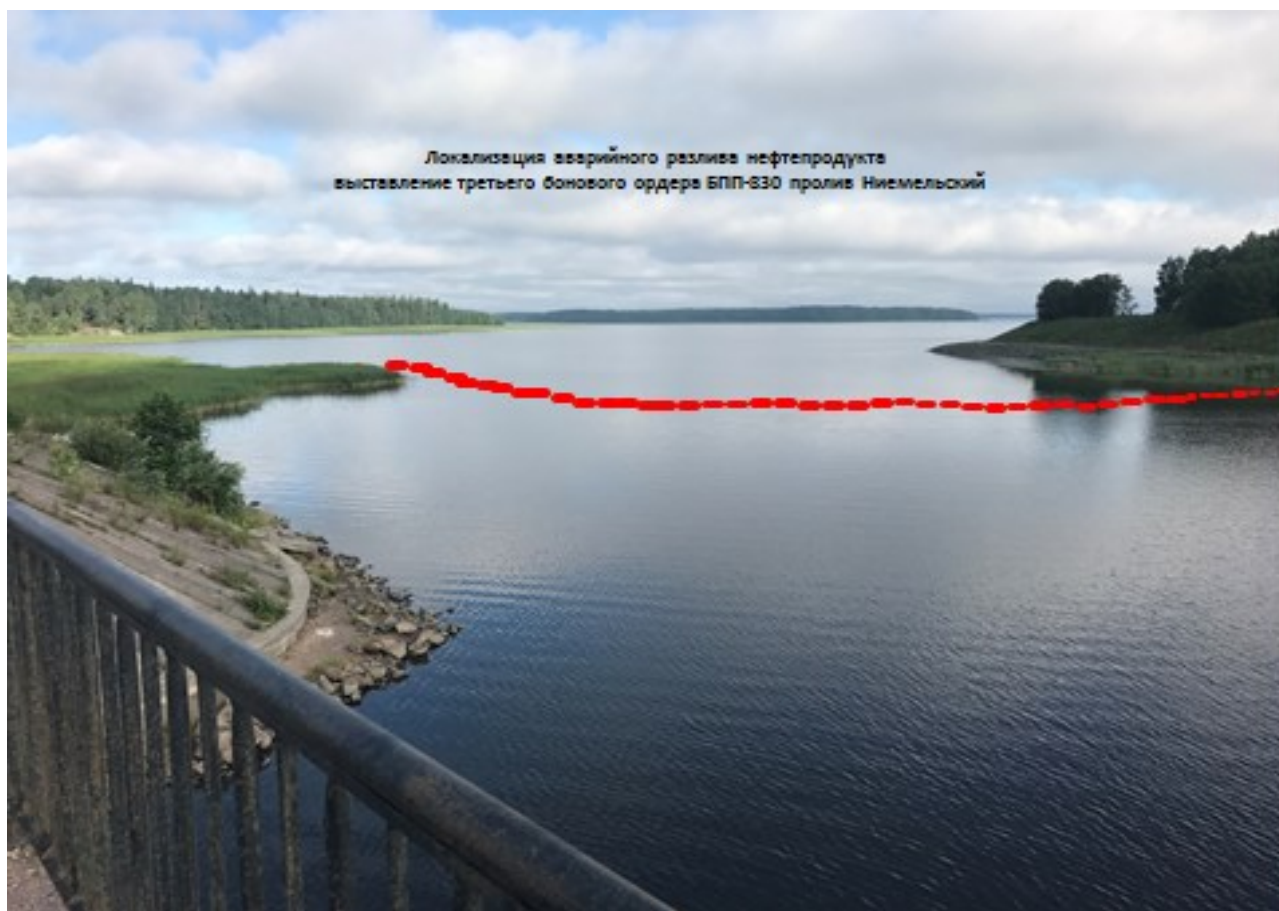
Рисунок 33 – Рубежи постановки боновых заграждений на проливе Ниемельский
