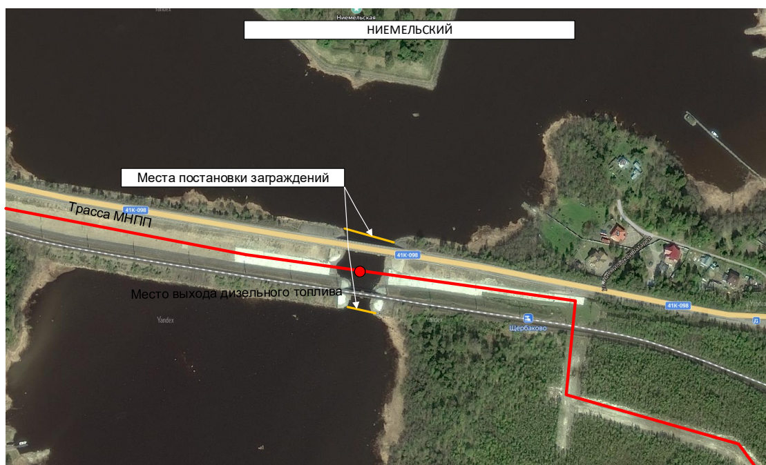
Рисунок 36 – Постановка заграждений в зимний период на проливе Ниемельский
