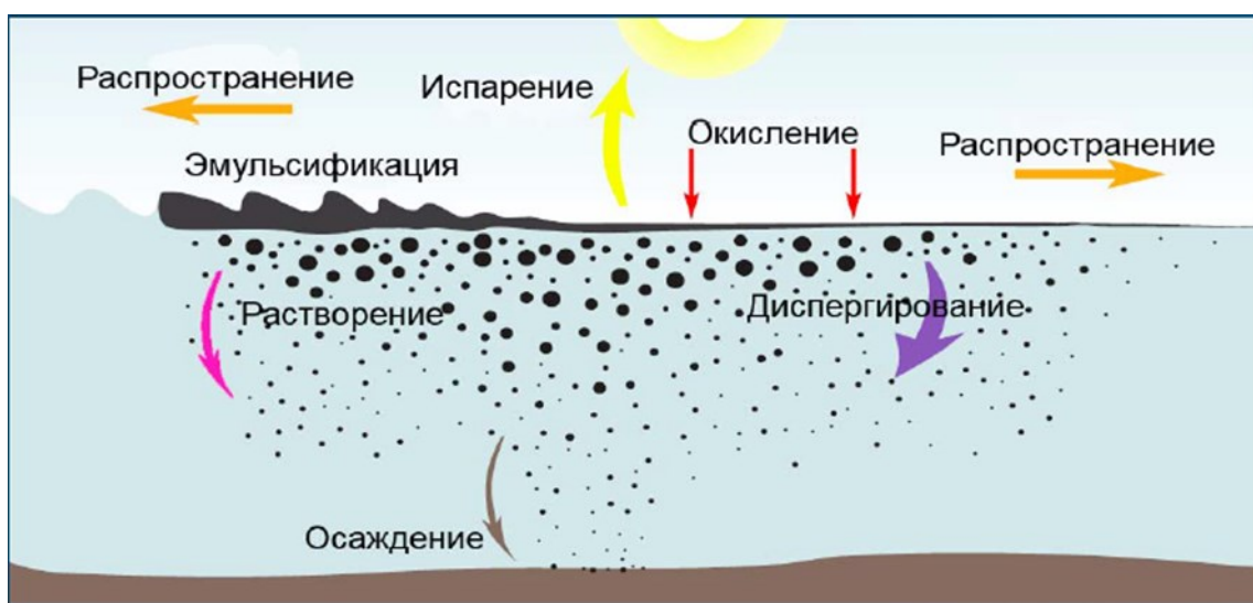
Рисунок 4 – Процессы, влияющие на распространение разливов дизельного топлива
