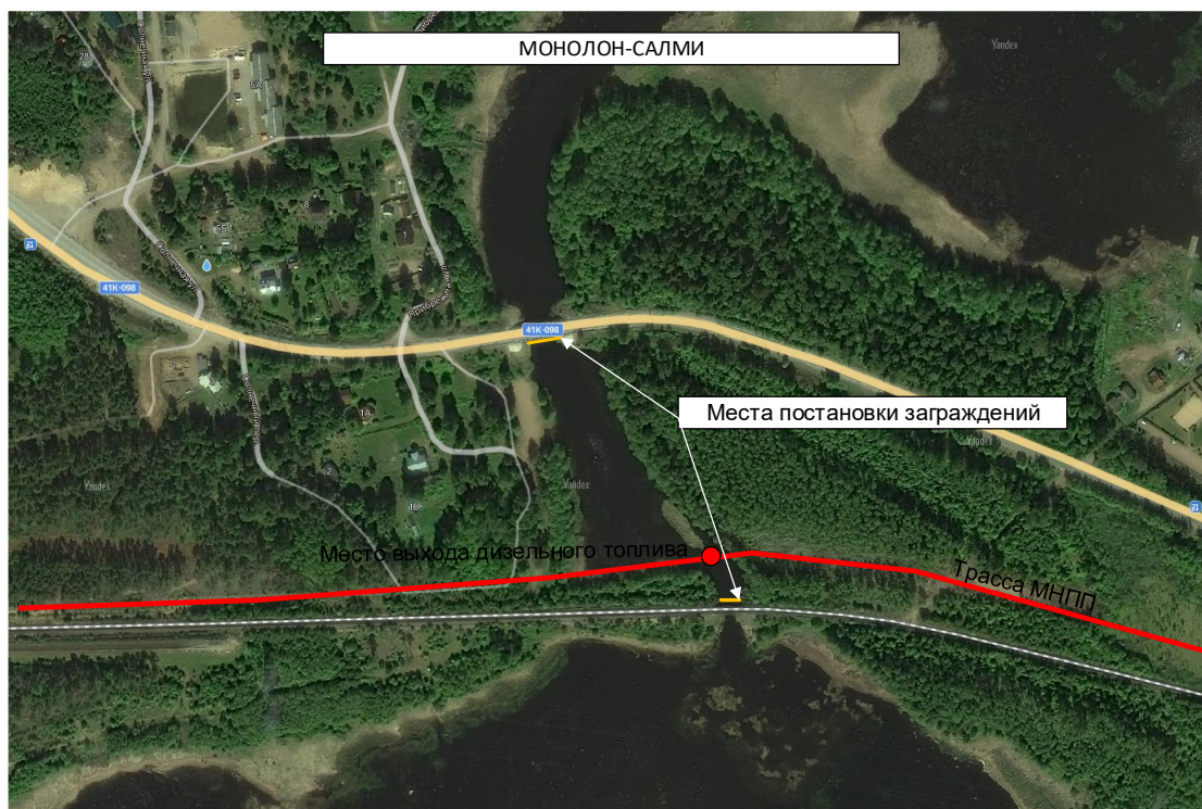
Рисунок 35 – Постановка заграждений в зимний период на проливе Монолон-Салми
