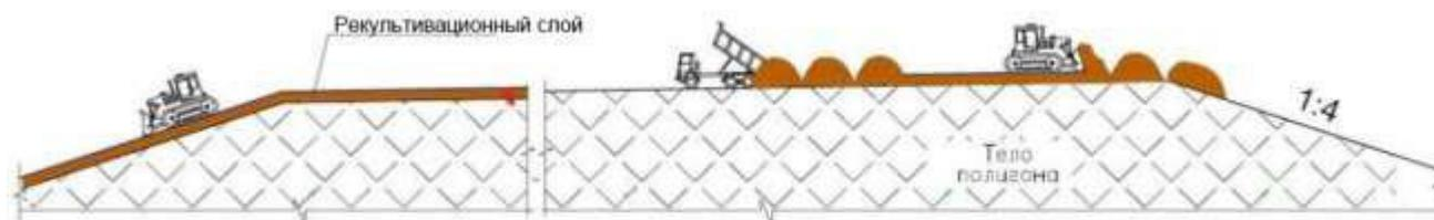
Рис. 2 – Условная схема формирования выравнивающего слоя
