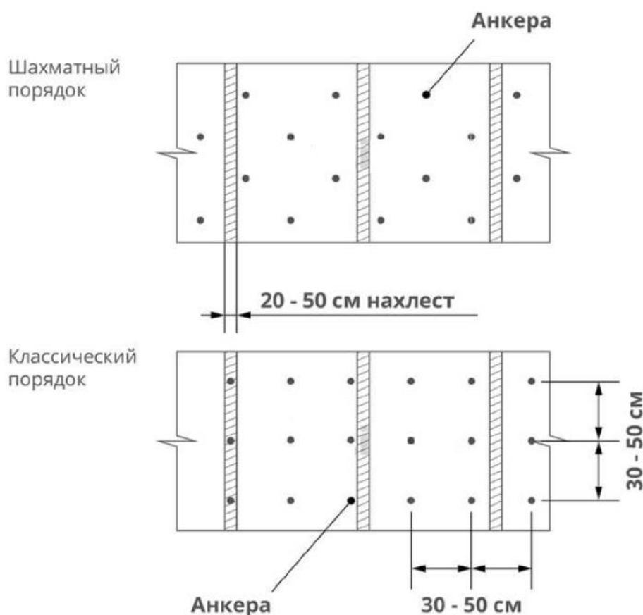
Рис. 5 – Схема анкеровки биоматов на поверхности склона
