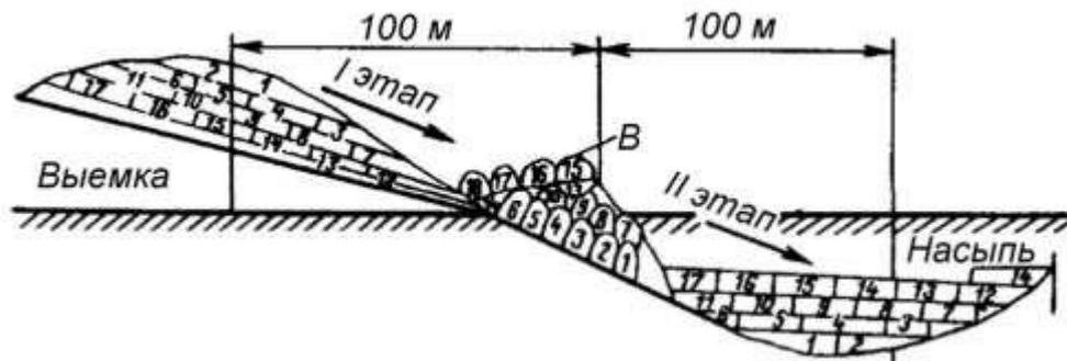
Рис. 4 – Условная Схема способа перемещения грунта в два этапа
