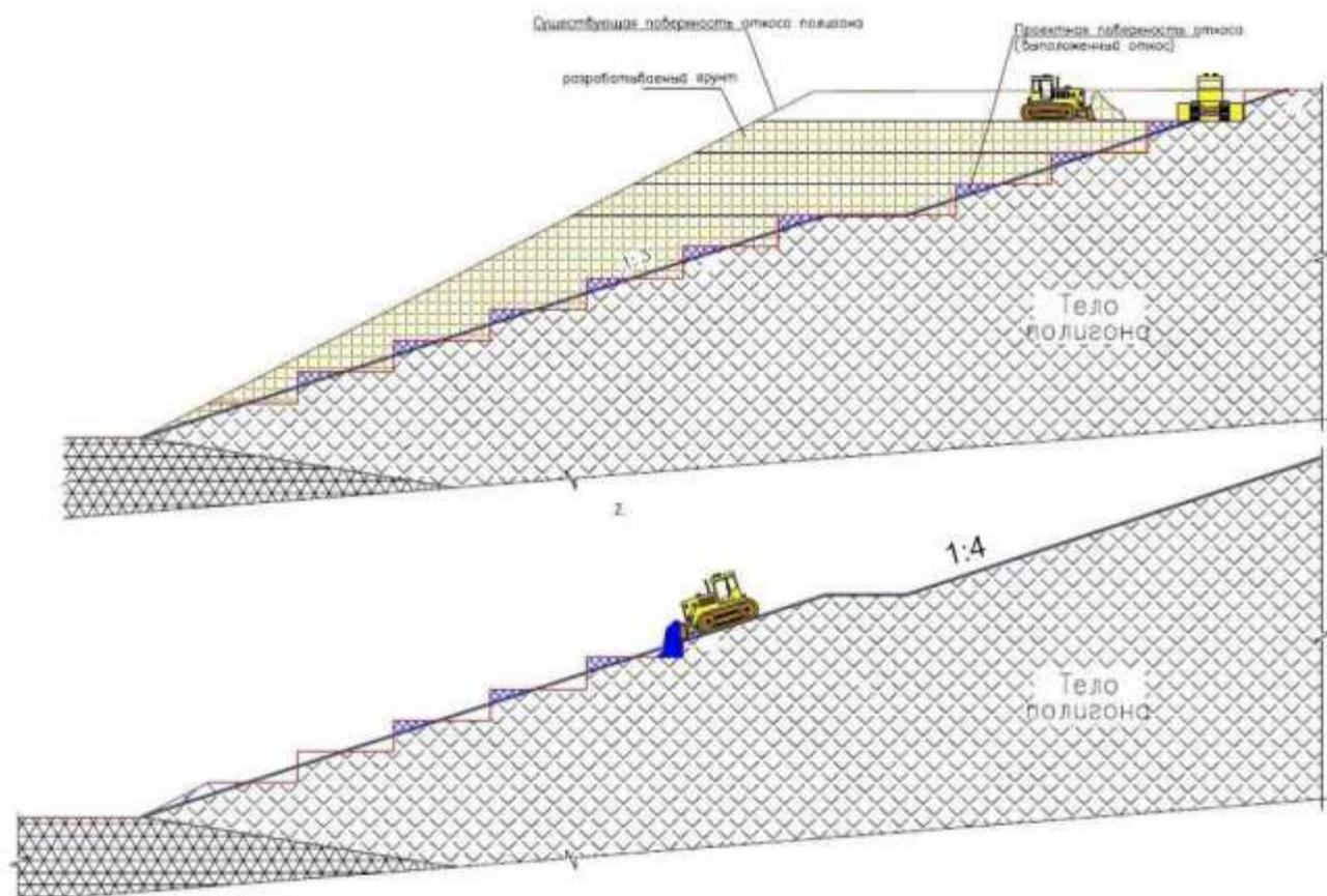
Рис. 1 – Условная схема выколаживания откосов
