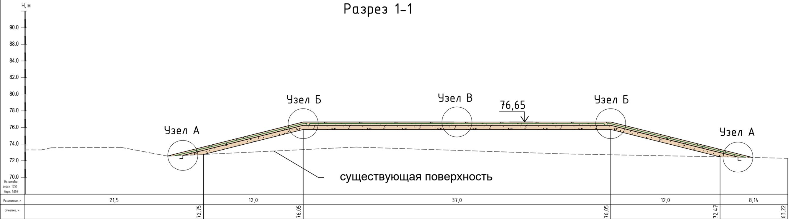
Узел А. Анкерная траншея крепления бентонитового мата
