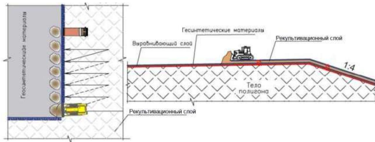
Рис. 3 – Условная схема формирования гидроизоляционного и защитного слоев
