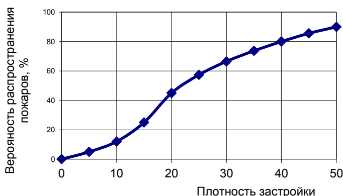
Рис. 4.4.2. Зависимость вероятности распространения пожаров от расстояния между зданиями
